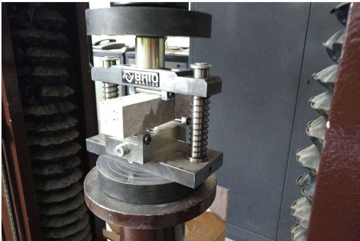
Obrázek 17: Uložení trámečku v lisu s nástavcem pro zkoušku pevnosti v tahu za ohybu
