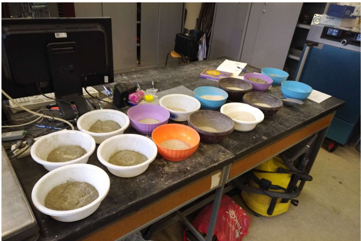
Obrázek 5: Veškerý materiál potřebný pro sadu zkoušek cementu od jednoho výrobce
