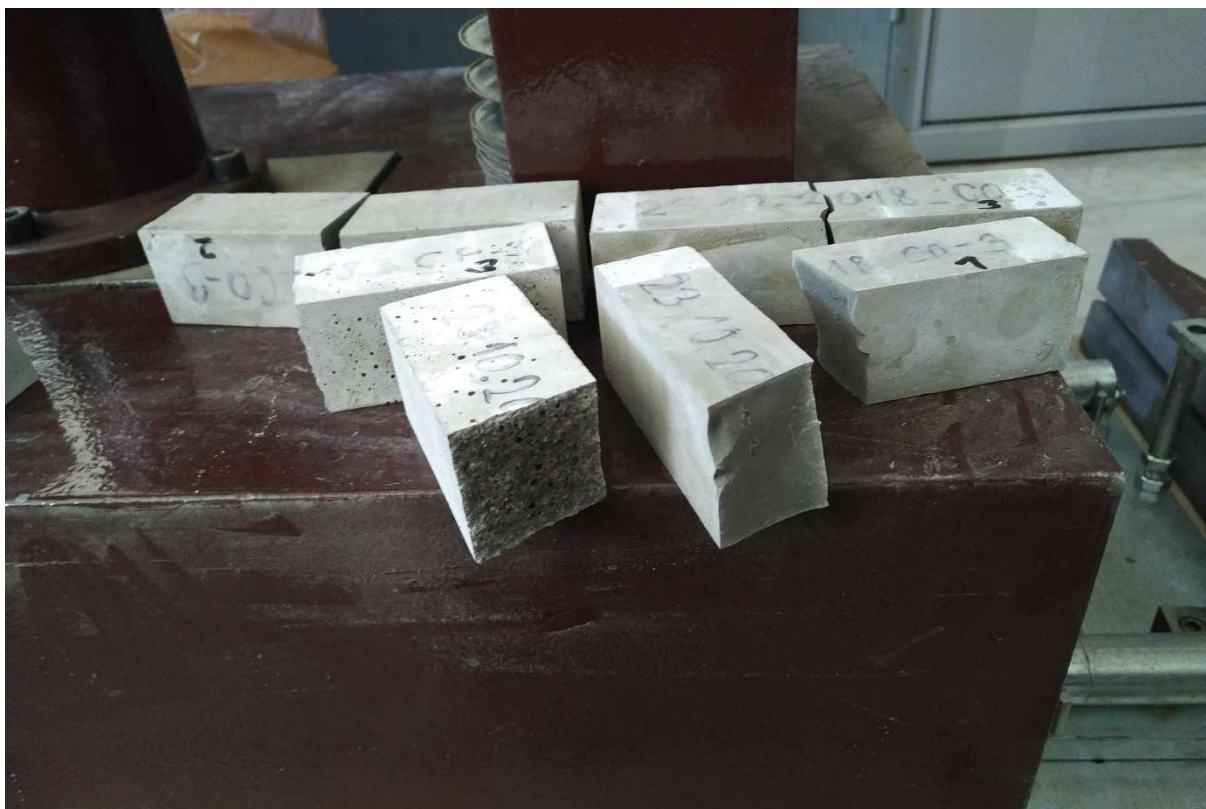
Obrázek 18: Porovnání lomu variant vzorků CP a C0
