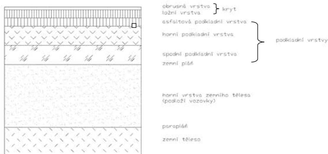
Obrázek 9 - Konstrukční vrstvy vozovky [4]
