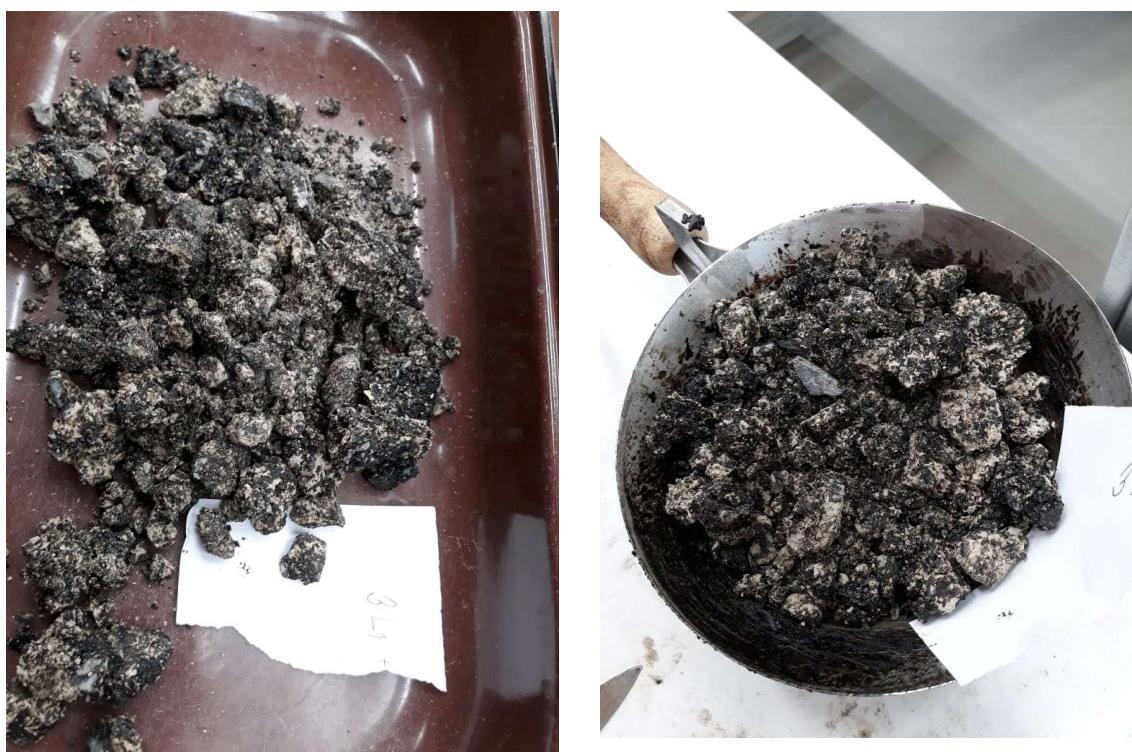
Obrázek 32 – Asfaltová směs s výskytem jílovité zeminy - vzorek B1L
