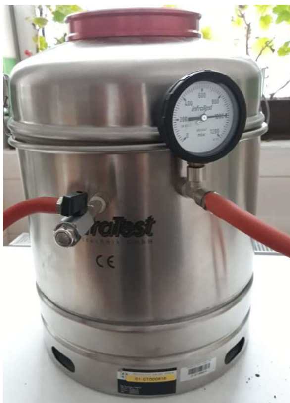
Obrázek 41 - Vakuová komora sloužící k odstranění zbylého zachyceného vzduchu v asfaltové směsi
