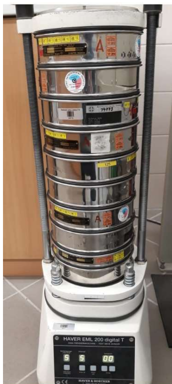
Obrázek 54 - Sestavená síta do sloupce s největší frakcí 11 mm a nejmenší 0,063 mm
