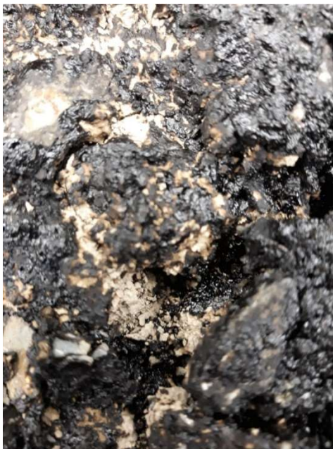
Obrázek 63 – Nedostatečné obalení zrn kameniva asfaltovým pojivem ve vzorku ALL1
