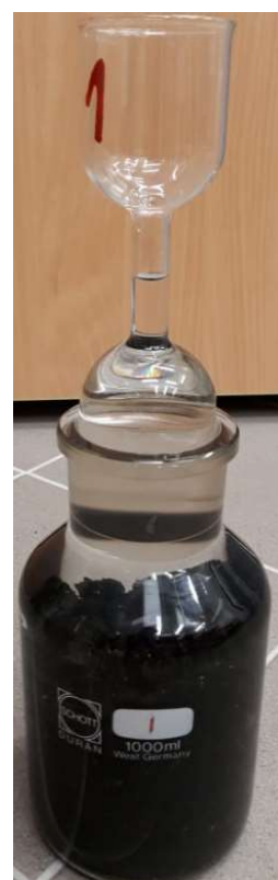
Obrázek 42 - Pycnometr naplněný odvzdušněnou destilovanou vodou po referenční značce
