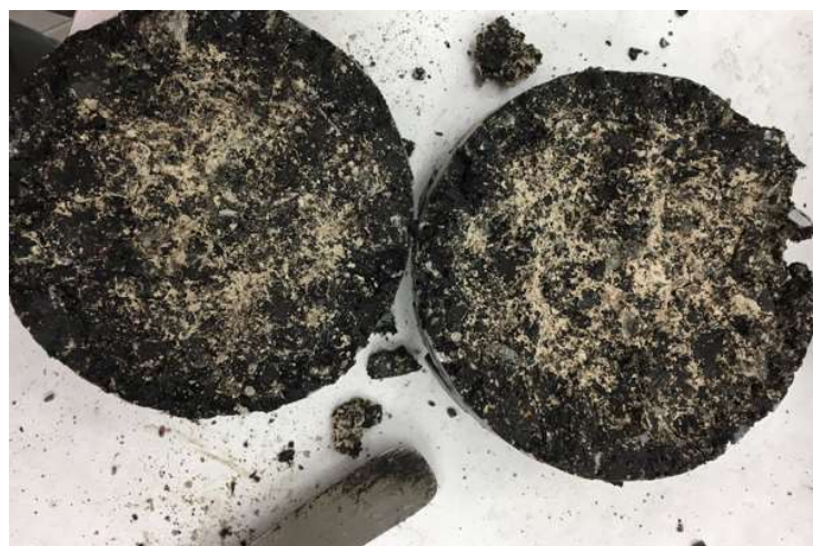
Obrázek 64 – Detail separovaných vrstev při zkoušce spojení kontaktních ploch s patrným výskytem jílovitých složek
