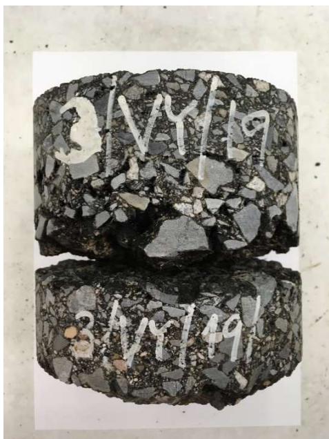
Obrázek 28 - Jádrový vývrt označený jako B1
