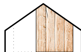
VYTVOŘENÍ TERASY ODEBRÁNÍM ČÁSTI DŘEVĚNÉHO JÁDRA, KOVOVÝ OBAL ZANECHÁN PO CELÉ DÉLCE
