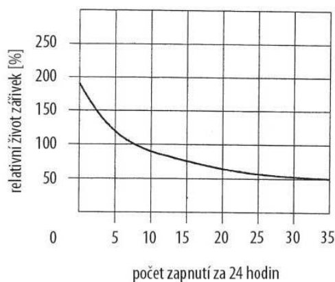
Obr. 11 Vliv počtu zapnutí na životnost zářivek (Převzato z [16])
