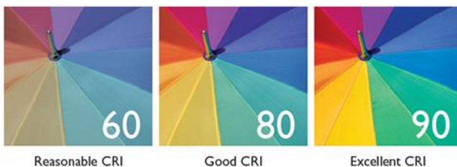
Obr. 6 Zobrazení barev při různém Indexu podání barev (Převzato z [13])
