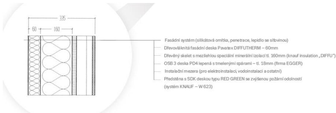
Obrázek č. 9 – Řez obvodovou stěnou energeticky úsporné certifikované konstrukce DIFFUWALL (Převzato z [17]).
