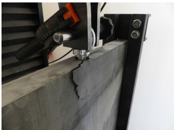
(a) Porušení za zkoušky tahem u kotvy tvořené pouzdrům s provlečenou výztuží
