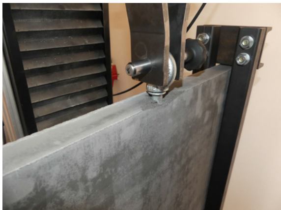
(a) Porušení za zkoušky tahem u přímé kotvy
