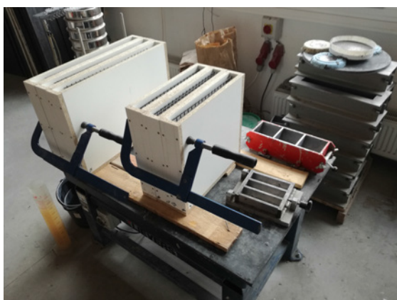
(a) Formy před betonáží
