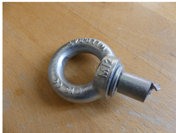
(b) Vytrhnuté závitové pouzdro přímé kotvy
