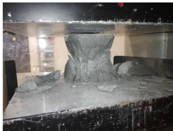
(b) Vzorek krychle po odzkoušení
