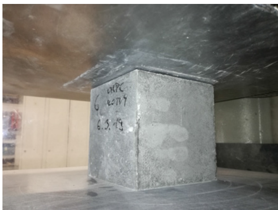
(a) Betonová krychle vložená do lisu
