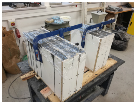
(b) Formy stáhnuté svěrkami a překryté fólií po vylití betonem
