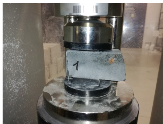
(b) Úlomek trámečku při zkoušce v tlaku
