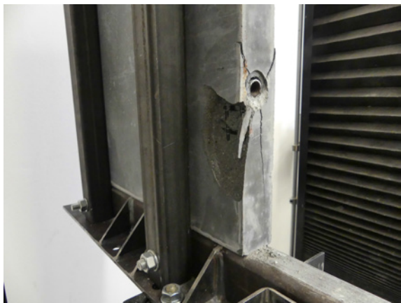
(a) Deska s opatřením po odzkoušení smykem
