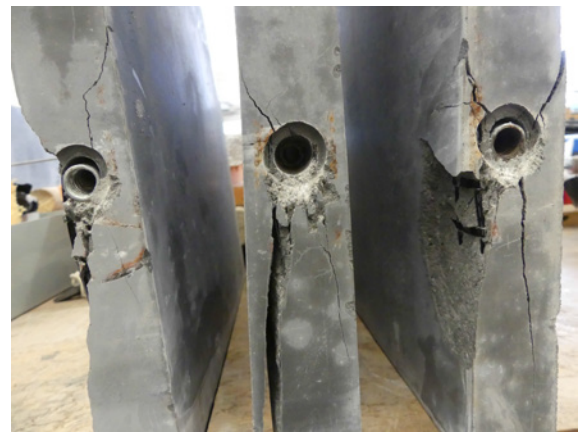
(b) Všechny tři vzorky s opatřením po odzkoušení smykem
