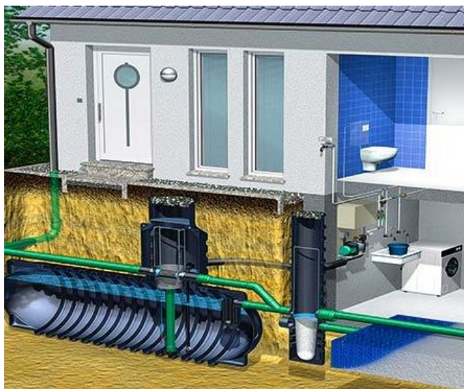
Obrázek 3_Schéma rozvodu vody-využití uvnitř objektu [7]
