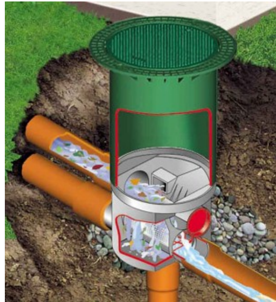
Obrázek 12_Šachtový (externí) filtr [2]
