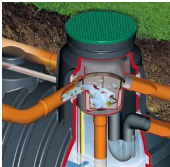
Obrázek 10_Košíčkový filtr-interní provedení [2]
