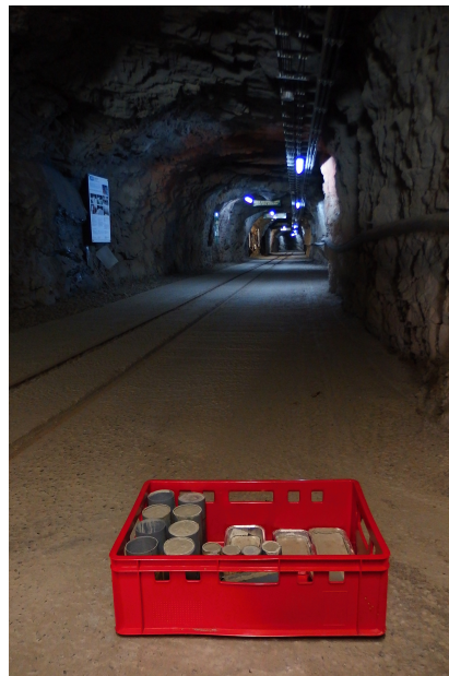
Obrázek 24: Simulace stálého půdního prostředí- zrání vzorků
