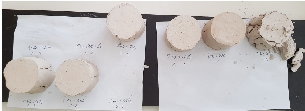
Obrázek 31: materiál 170 kaolín Bechyně po vyjmutí z lisu zkoušky na tlakovou pevnost
