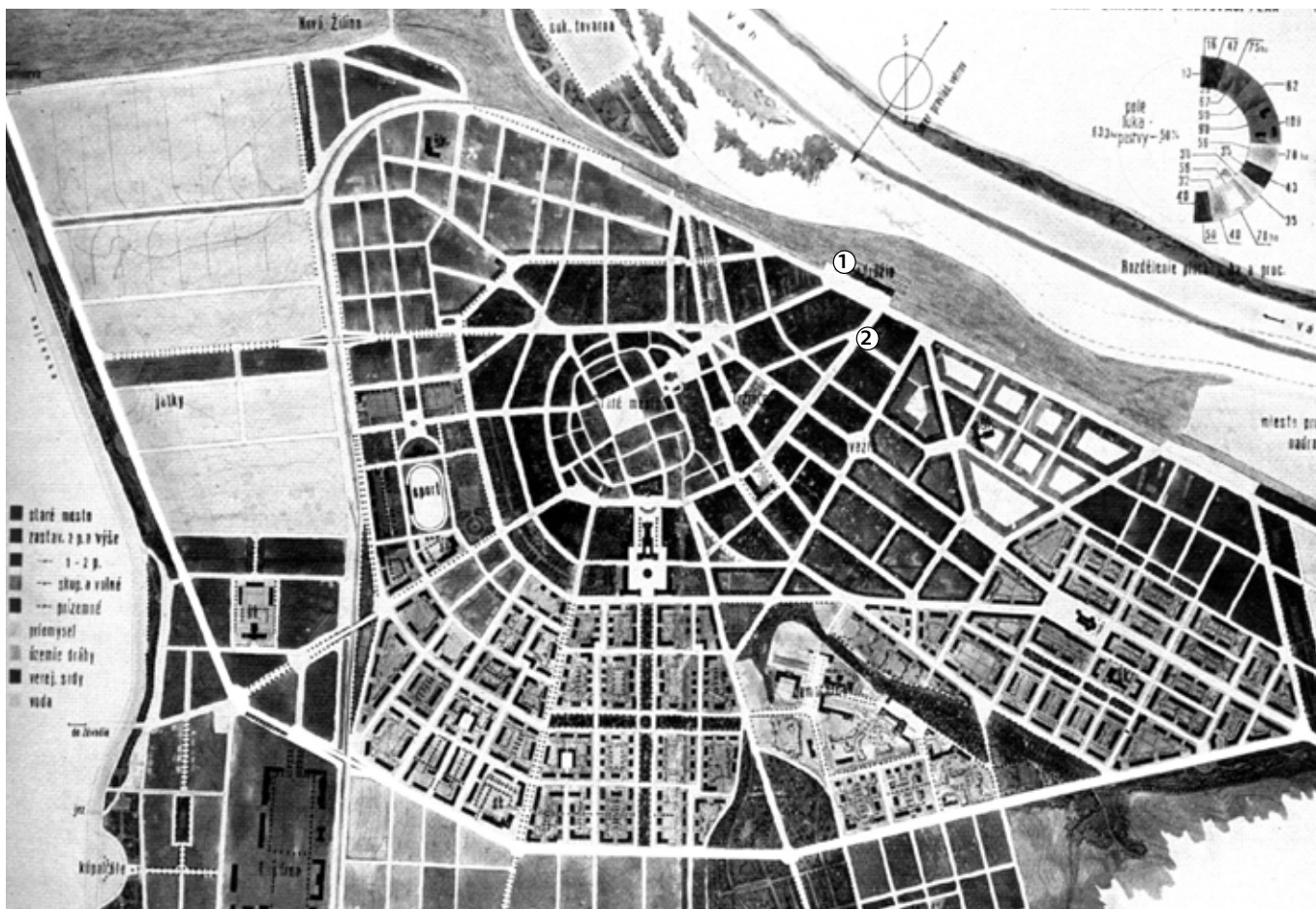
výrez víťazného súťažného návrhu na regulačný plán mesta z roku 1929, architekt Peňáz [2] predstaničné námestie (1) a bloková zástavba v mieste AS (2), navrhovaný je okružno-radiálny dopravný systém platný dodnes
