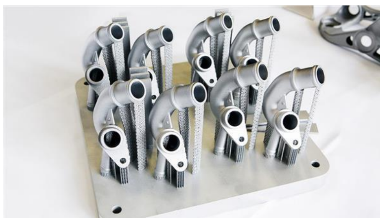
Obr. 2: Výtisky přivařené k základní desce [1]
