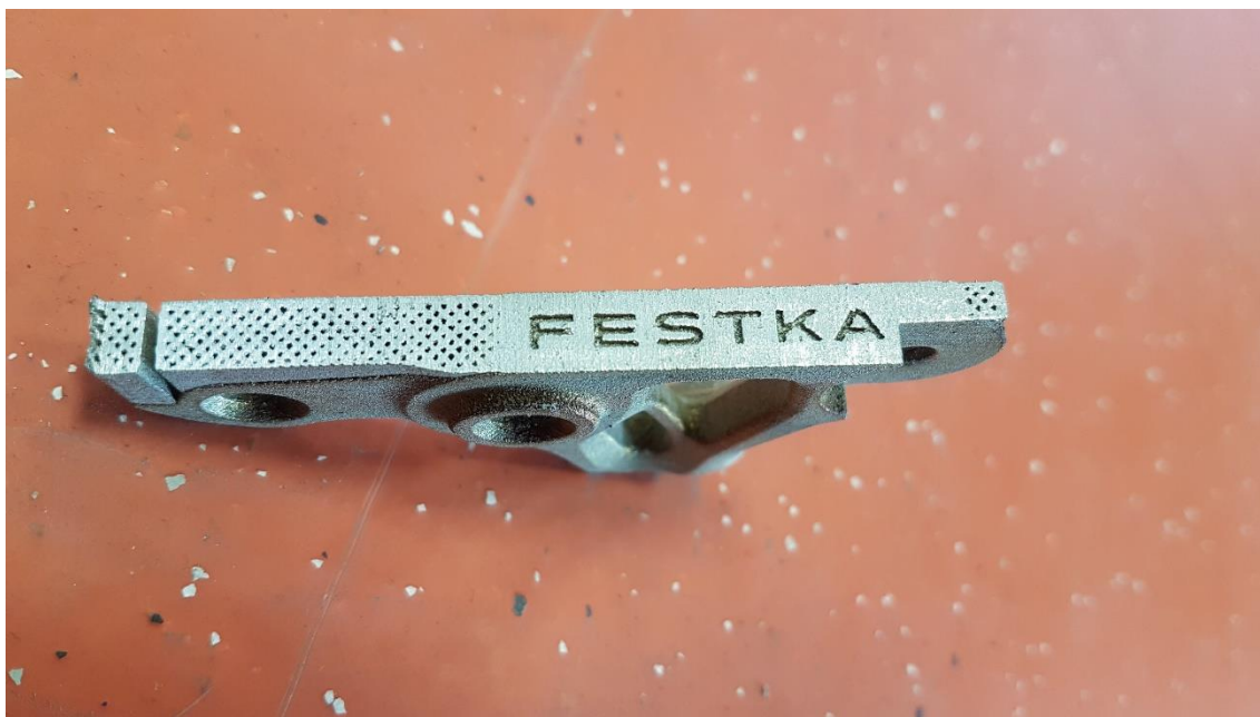
Obr. 7: Povrch po odříznutí výtisku na pile
