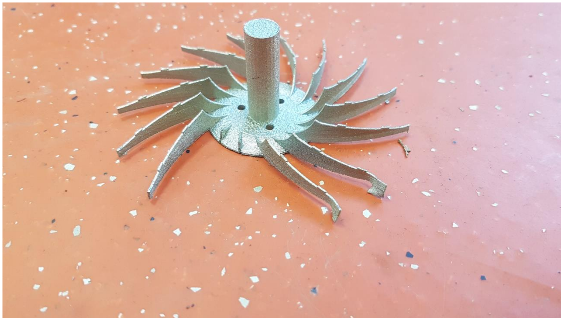
Obr. 9: Výtisk s viditelným poškozením od pilového pásu
