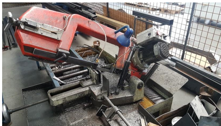
Obr. 3: Běžná dílenská pila s hydraulickým válcem Bomar STG 220
