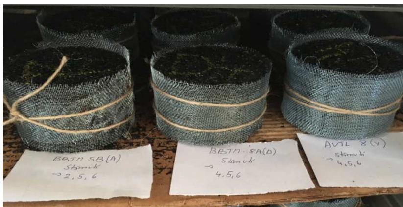
Obrázek 38: Obalení těles ocelovou síťovinou
