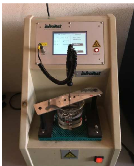
Obrázek 26: Přístroj pro zkoušku kroužek a kulička
