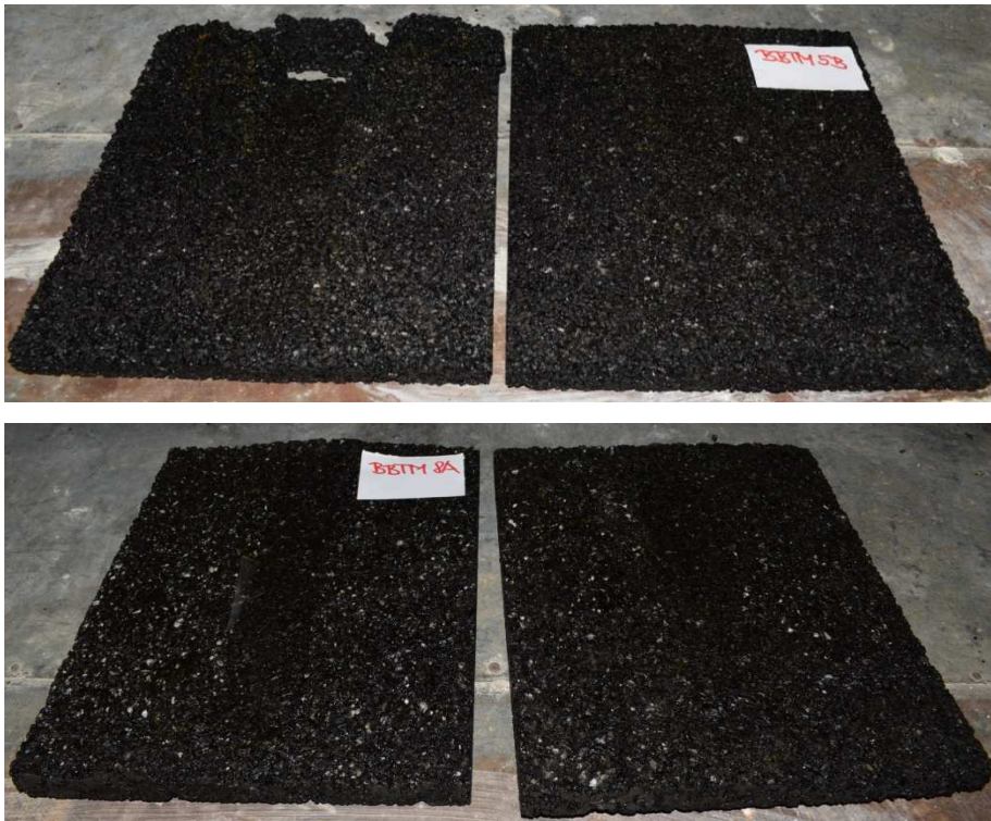
Obrázek 45: Vyjeté koleje směsi BBTM 5B a BBTM 8A (desky tl. 2 cm)
