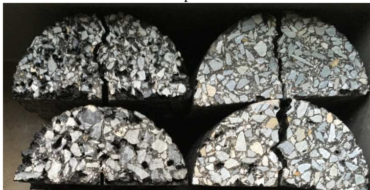
Obrázek 41: Zkušební tělesa po odzkoušení
