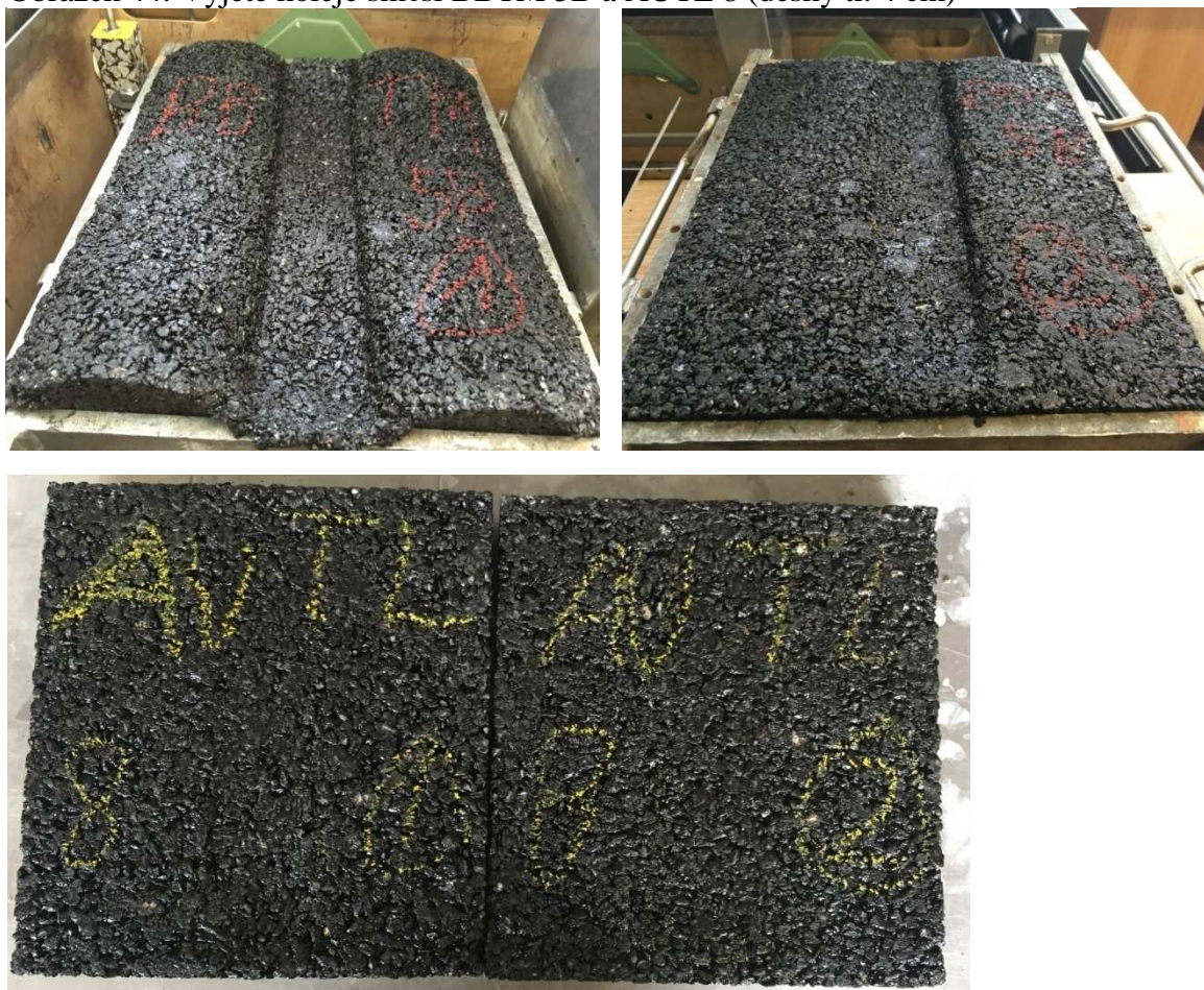
Obrázek 44: Vyjeté koleje směsi BBTM 5B a AUTL 8 (desky tl. 4 cm)
