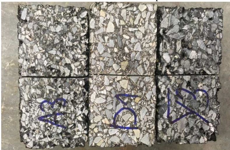
Obrázek 39: Půlválcová zkušební tělesa opatřená drážkou
