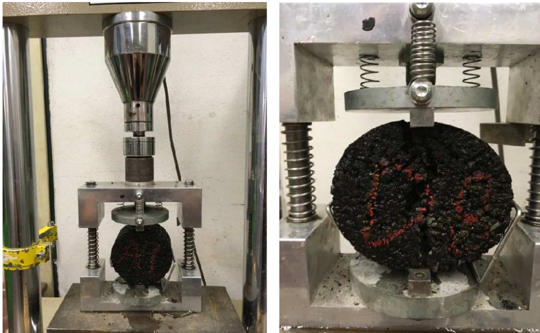
Obrázek 42: Zkušební zařízení pro stanovení ITS
