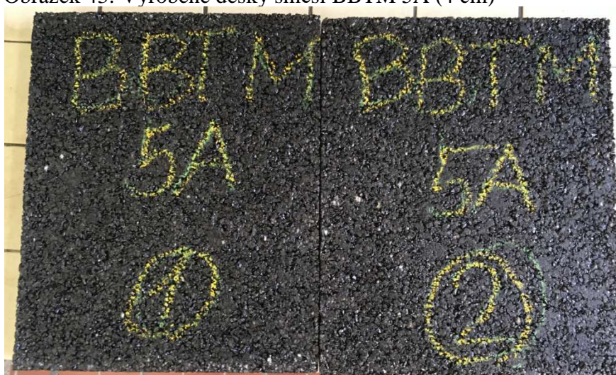
Obrázek 43: Vyrobené desky směsi BBTM 5A (4 cm)
