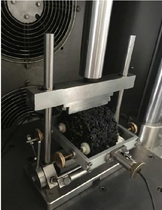
Obrázek 37: Zkušební sestava pro stanovení modulu tuhosti
