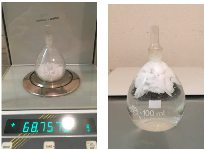
Obrázek 32: Guy-Lussacův pyknometr pro zjištění obj. hm. parafínu
