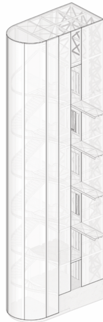
INŠTALÁCIA VÝTAHOV A FINÁLNE OPLÁŠTENIE SKLOM
