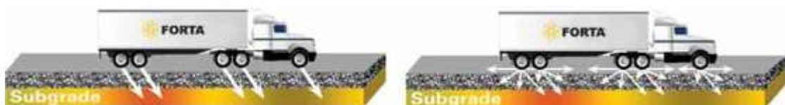
Obrázek 13 Roznos zatížení při akceleraci a brzdění pod nevyztuženou/vyztuženou směsí [12]
