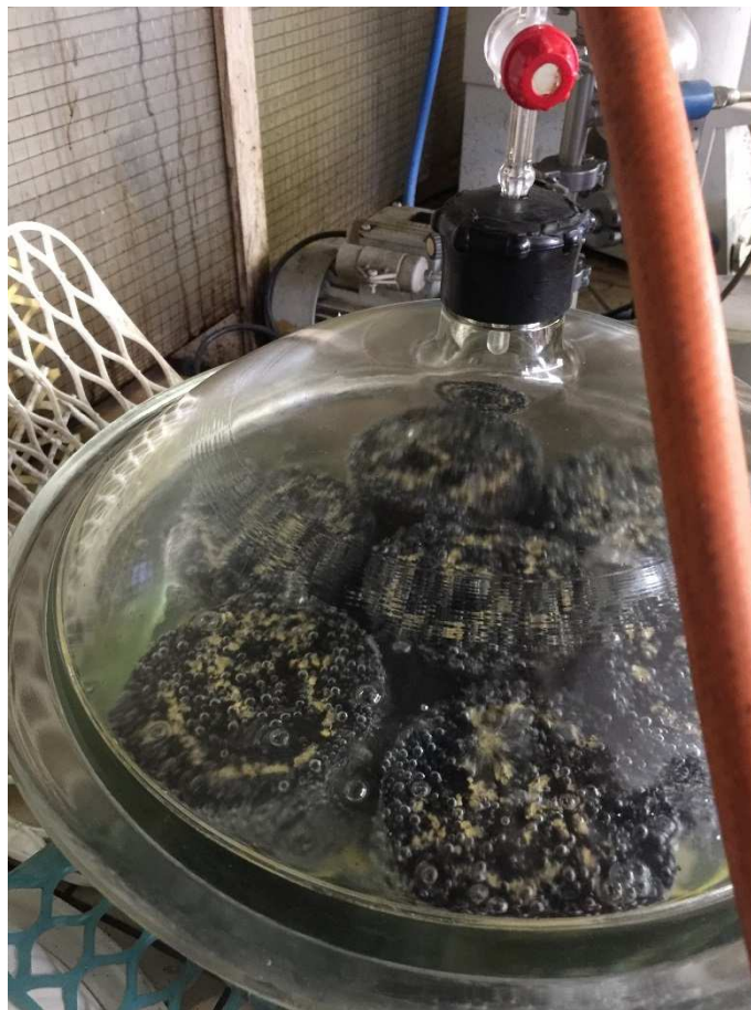
Obrázek 29 Sycení těles v podtlakové komoře
