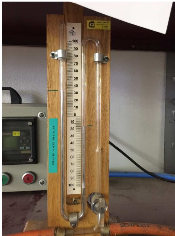
Obrázek 30 Podtlak vyjádřený výškou rtuťového sloupce
