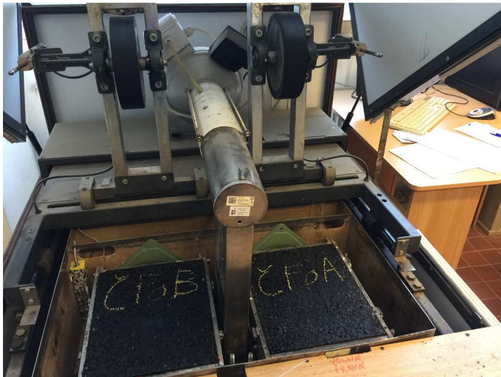
Obrázek 37 Desky v měřícím zařízení po 10 000 cyklech
