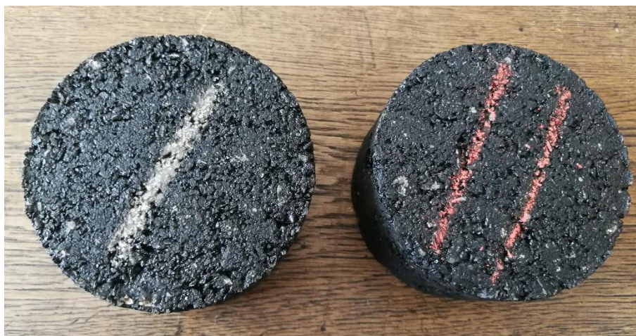
Obrázek 21: Válcová tělesa ACL 16 S zhutněná 2 x 75 úderů (vlevo je směs bez R-materiálu a vpravo směs obsahující R-materiál)
