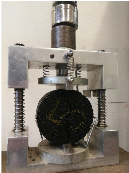
Obrázek 25: Upevnění zkušebního tělesa pro zkoušku ITS
