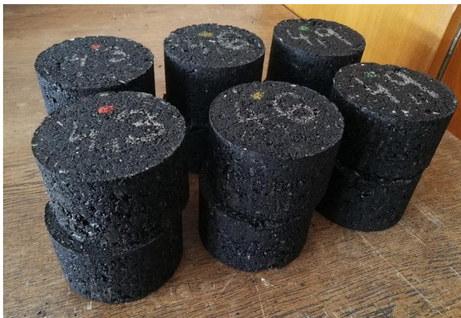
Obrázek 18: Válcová tělesa 2 x 75 - ACL 16 S bez R-materiálu - 1. optimalizace
