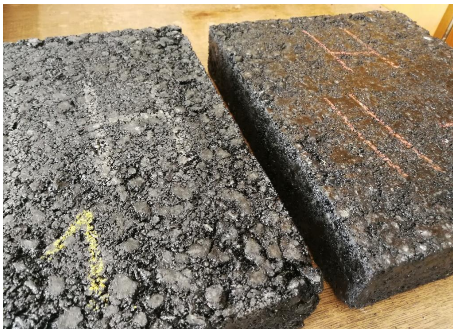
Obrázek 22: Desky ACL 16 S (vlevo je směs bez R-materiálu a vpravo směs obsahující R-materiál)
