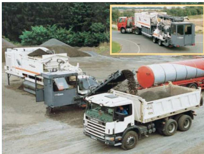
Obrázek 2: Recyklace v míchacím centru za studena [10]
