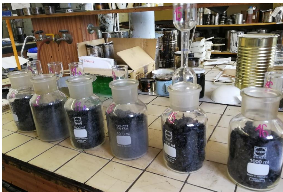
Obrázek 17: Navážka v pyknometru pro stanovení maximální objemové hmotnosti
