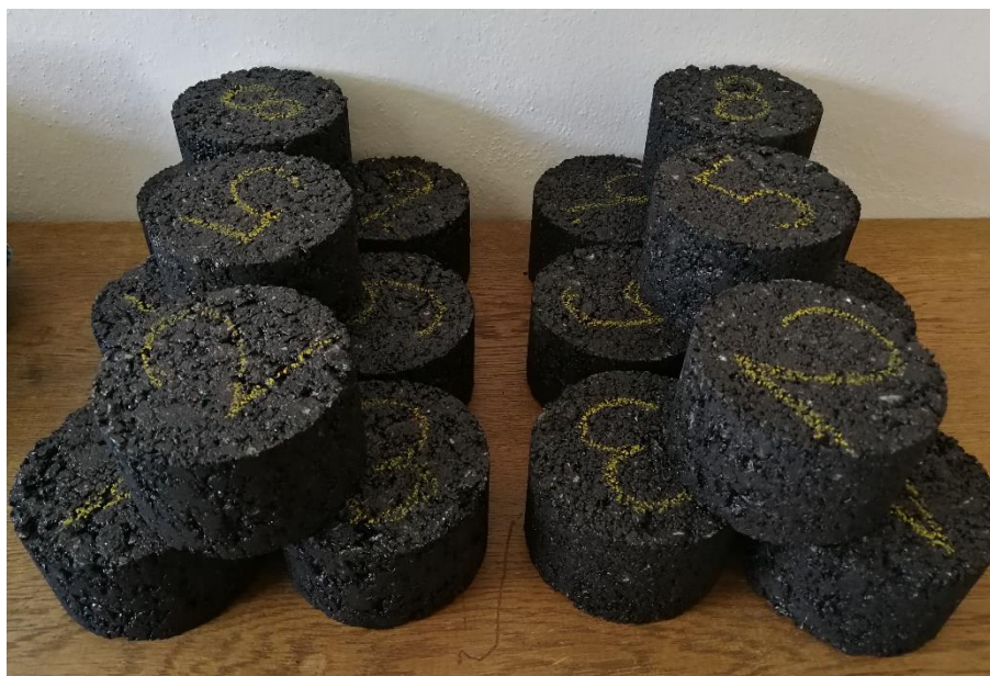
Obrázek 23: Válcová tělesa ACL 16 S zhutněná 2 x 25 údery (vlevo je směs bez R-materiálu a vpravo směs obsahující R-materiál)
