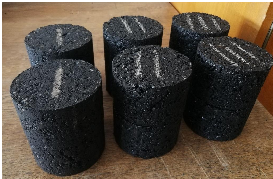
Obrázek 20: Válcová tělesa 2 x 75 - ACL 16 S bez R-materiálu - 2. optimalizace
