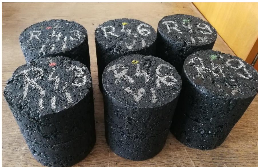
Obrázek 19: Válcová tělesa 2 x 75 - ACL 16 S s R-materiálem - 1. optimalizace
