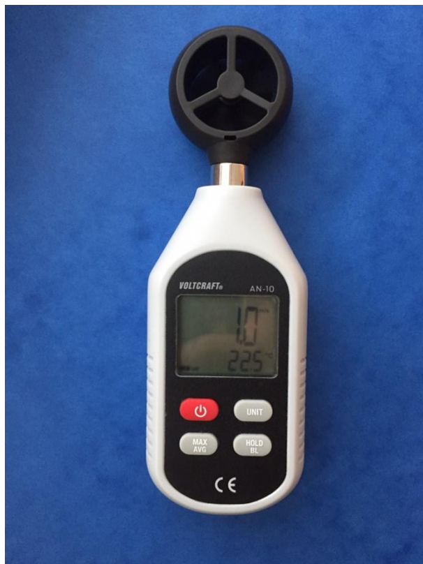
Obrázek 18: Anemometr – zařízení pro měření rychlosti vzduchu a teploty.
