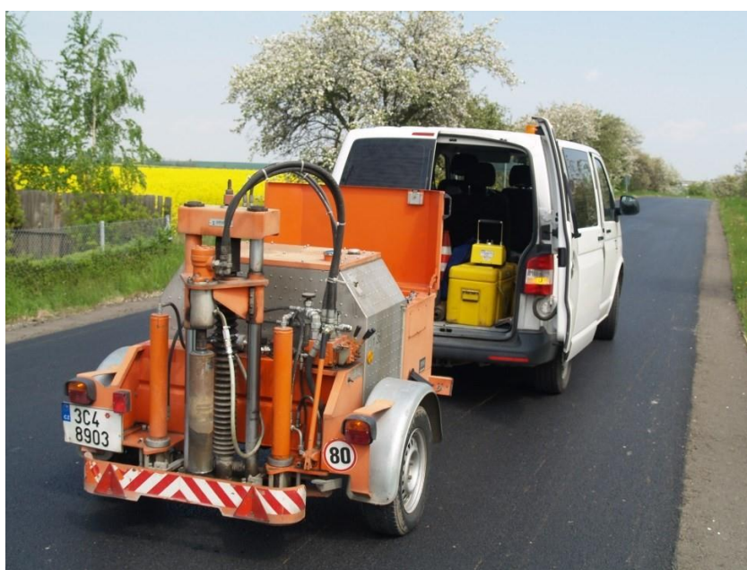
Obrázek 14: Vrtná souprava pro odběr vzorku [26].
