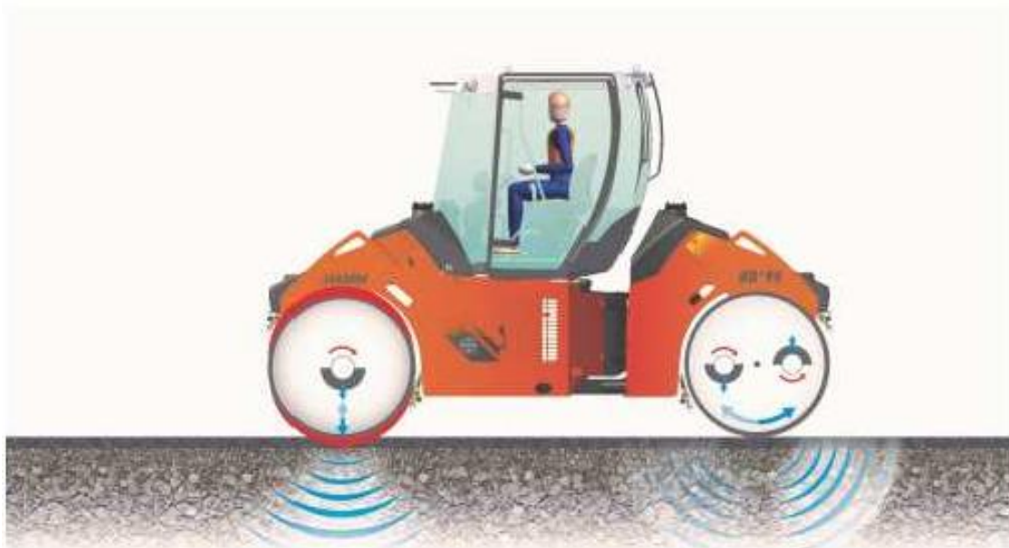
Obrázek 8: Schéma válce skupiny a) válec s jedním oscilačním běhounem (vpravo) a druhým vibračním běhounem (vlevo) [1].
