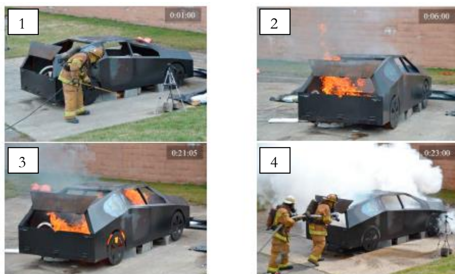
Obrázek 12 Zobrazení průběhu požáru Li – iontových baterií při testování proti ohni; 1- zapálení baterie propanovým hořákem, 2 - vzplanutí baterie, 3 - průběh požáru po odstranění hořáku, 4 - průběh požáru po zhabájení hašení [22].
