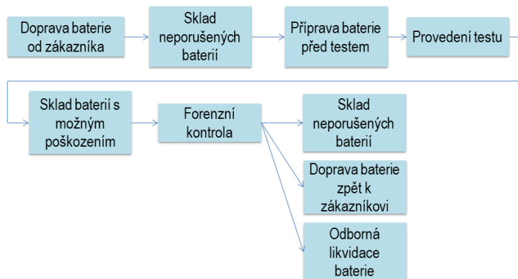
Obrázek 11 Schematické zobrazení procesu testování baterie.
