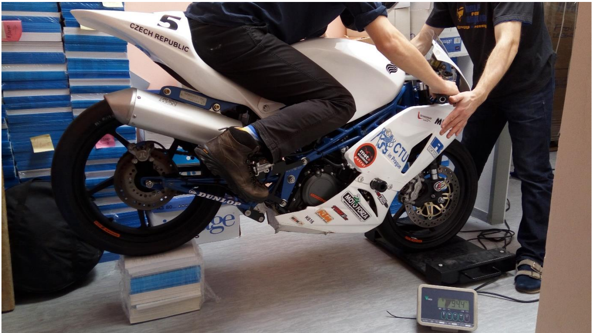
Obrázek 26 - Měření výškové polohy těžiště s jezdcem v druhé poloze
