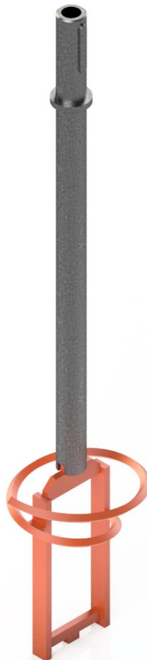
Obr. 24 Model upraveného míchacího hřídele
