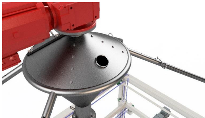
Obr. 17 Předpřipravený přívod betonu do zásobníku
