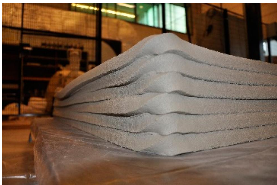
Obr. 10 Kroucení betonu při použití trysky nekruhového průřezu [7]
