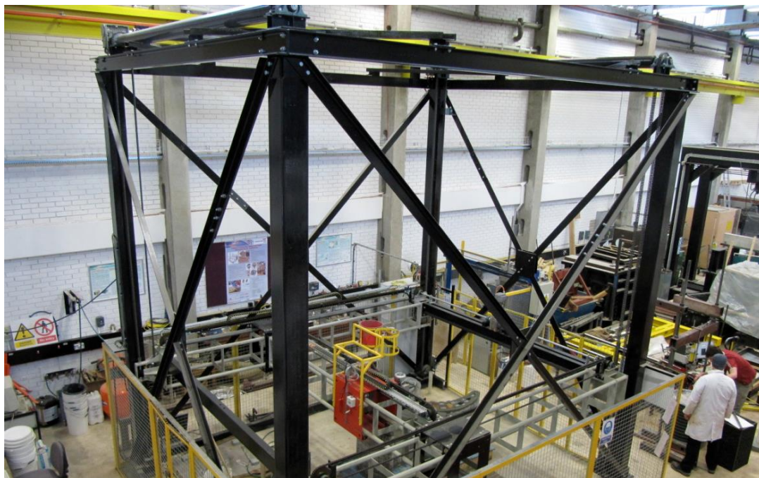
Obr. 2 Portálový stroj pro testování optimálních vlastností betonových směsí pro 3D, výzkum univerzity Loughborough [3]
