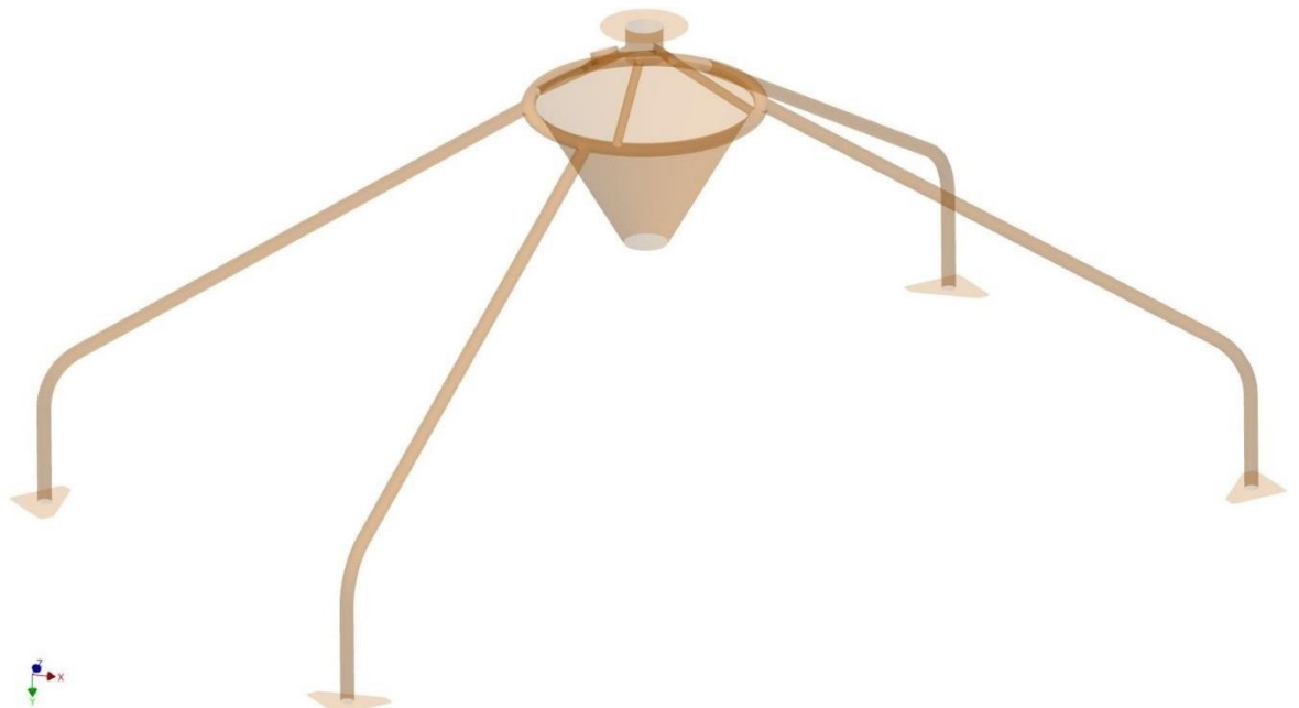
Obr. 48 Plošný model pro numerickou analýzu zařízení malé tiskárny
