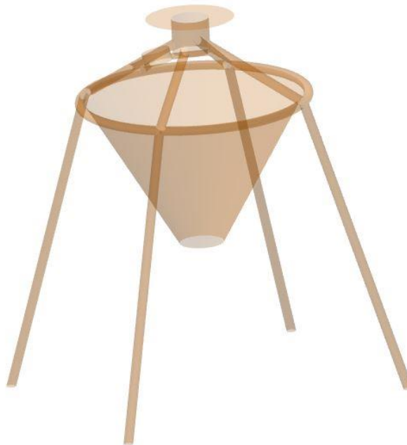
Obr. 47 Plošný model pro numerickou analýzu míchacího zařízení velké tiskárny
