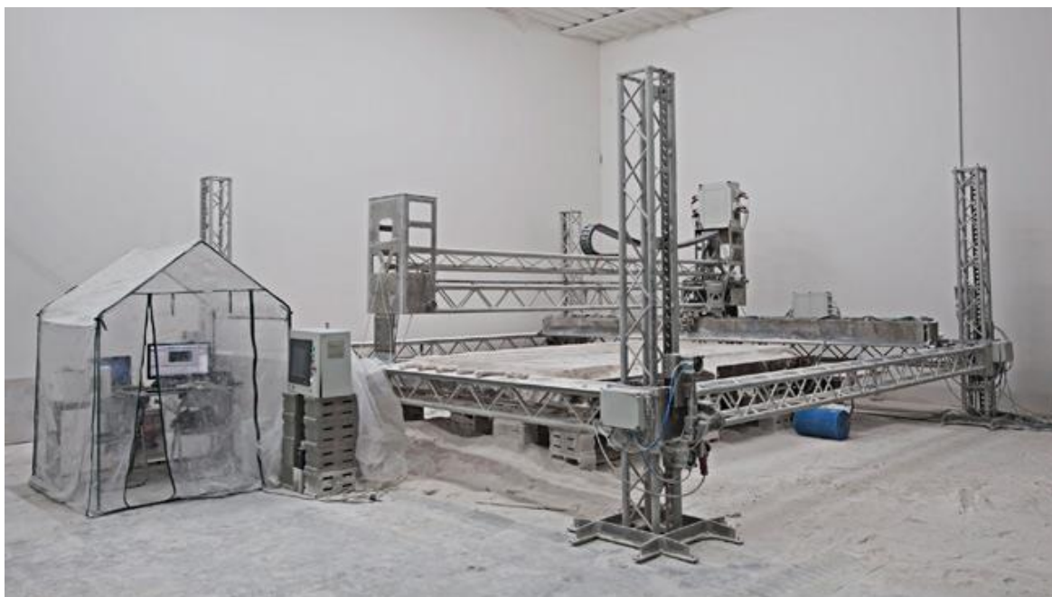
Obr. 3 Stroj pro 3D tisk metodou stereolitografie, kde je vstupním materiálem písek, firmy D-Shape [6]
