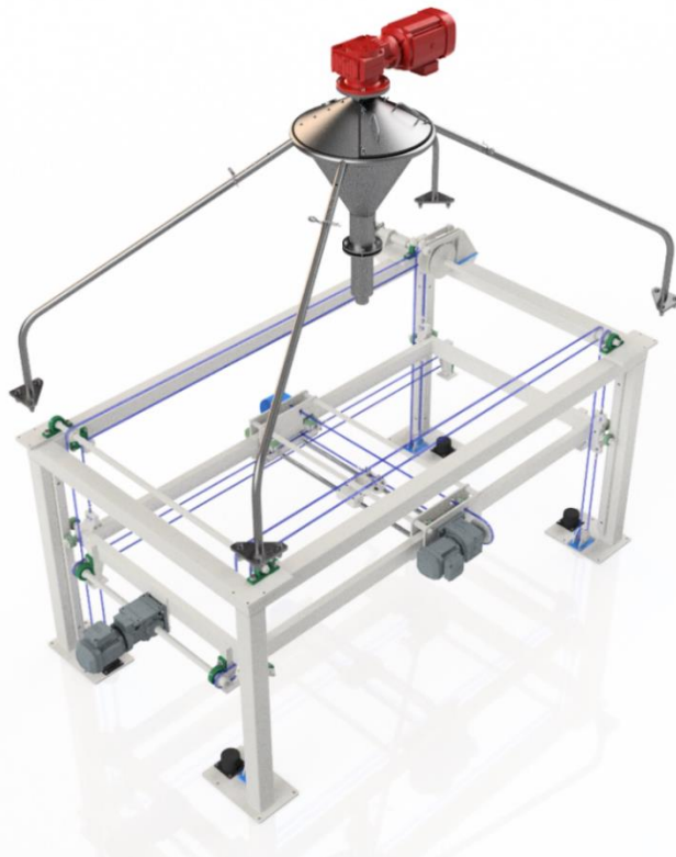
Obr. 12 Zařízení pro testování betonové směsi (malá tiskárna)
