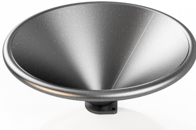
Obr. 19 Kuželový tvar zásobníku, druhý návrh
