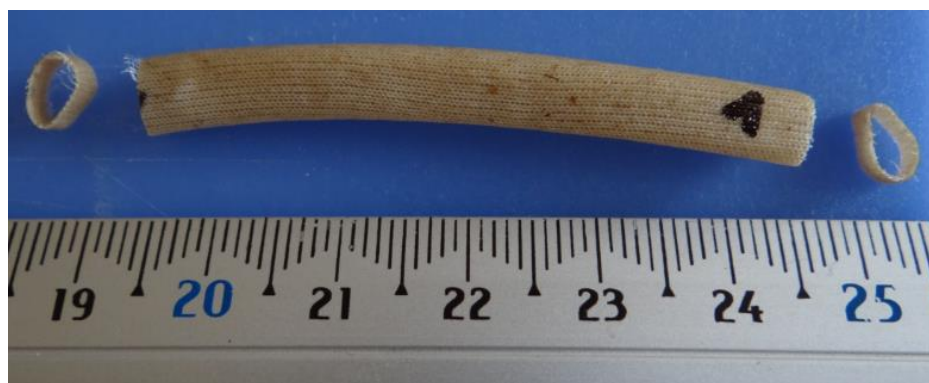
Obrázek 10 - Vzorek protězy s úšřížky pro měření geometrie
