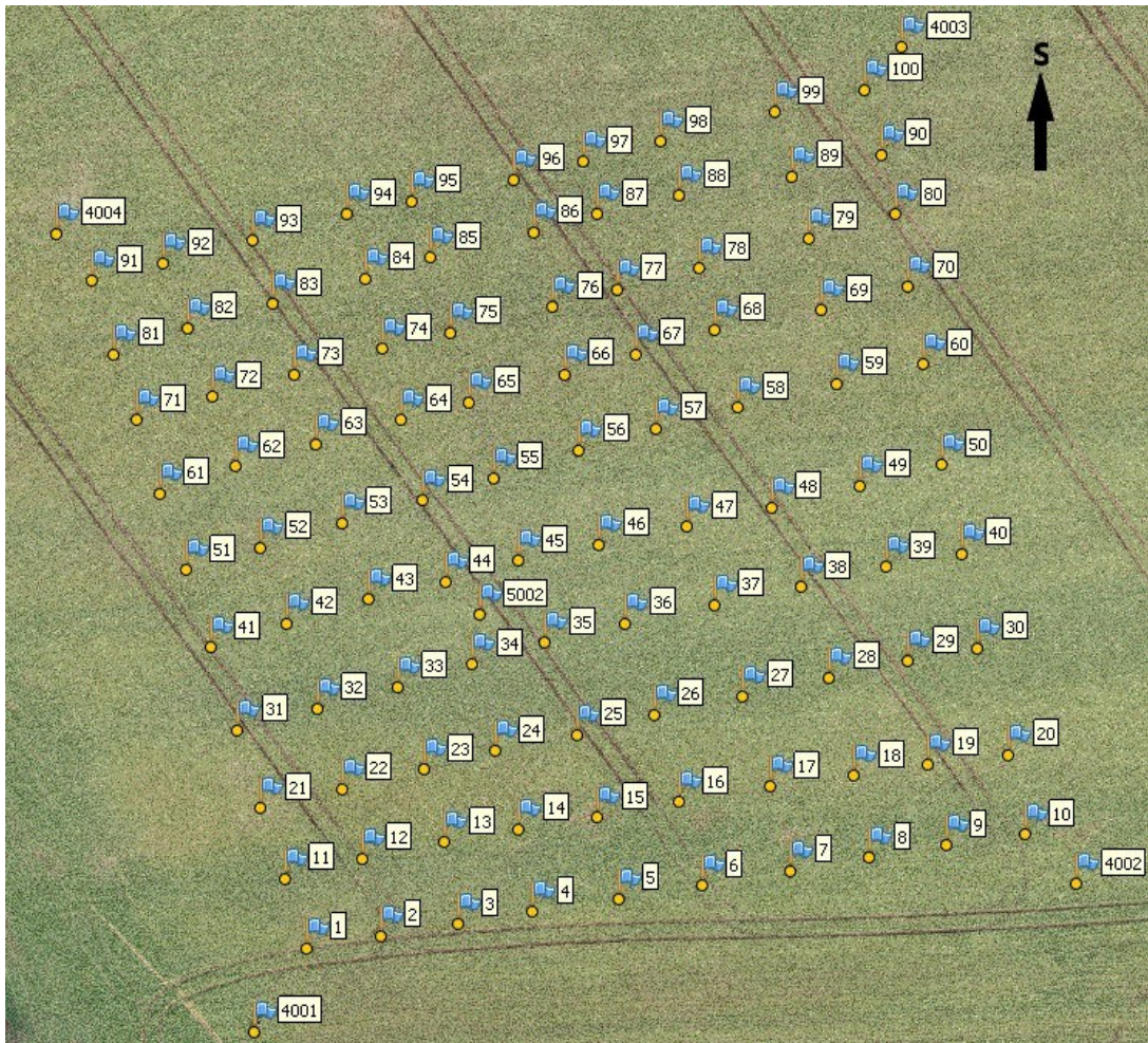
Obr. 17 - Rozmístění vlíčovacích bodů s body bodového pole a volným stanoviskem
