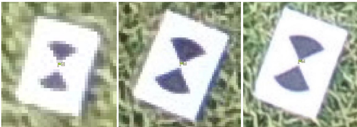
Obr. 26 - Ukázka určování vlíčovacích bodů pro letovou hladinu 40 m, 25 m a 15 m
