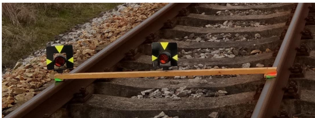
Obrázek 43: Rozchodka s pevnými cíli firmy Pragema, s.r.o., schválená SŽG
