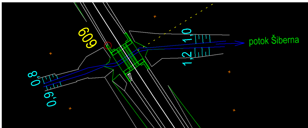
Obrázek 51: Železniční most přes potok Šiberna na km 17,610 ve 2D (na levé straně mostu bod ŽBP č. 609)
