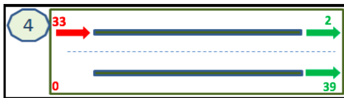
Obrázek 27: Kapacita při využívání jedné dráhy pouze pro odlety a druhé pro smíšený provoz [vlastní zpracování]
