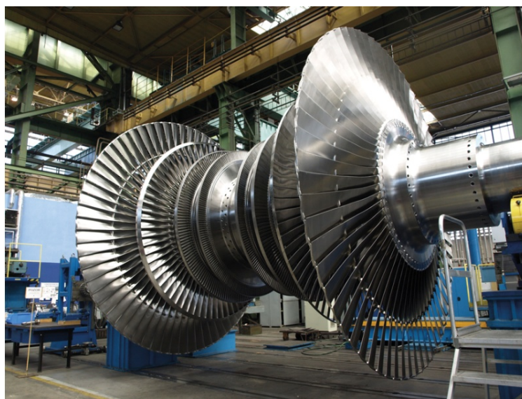
Obr. 2: Oběžné lopatky posledního stupně nízkotlakého rotoru parní turbíny v jaderné elektrárně Temelín [4]
