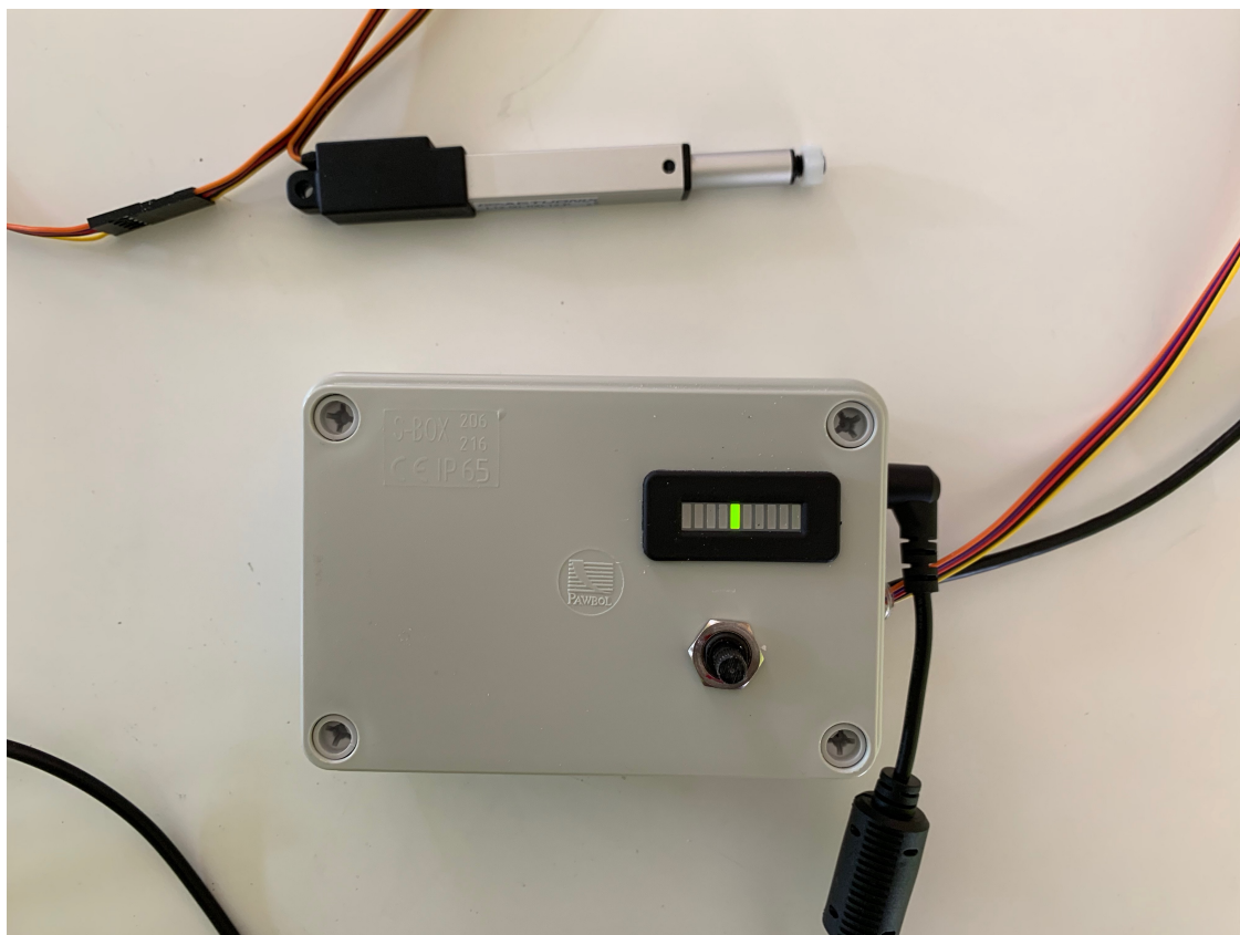
Obr. 47: Smontovaný plastový kryt IP67 s aktivním indikátorem polohy
