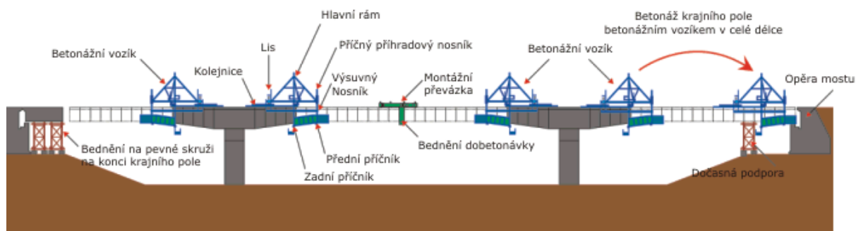
Obr. 15. Schéma provádění letmé betonáže [14]
