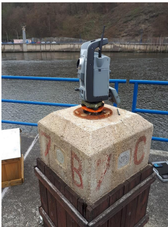
Obr. 12 - Totální stanice Trimble S8 umístěná na pilíři P7
