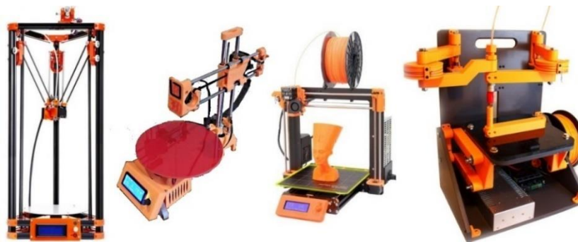
Obr. 17 V pořadí zleva tiskárna delta, polar, kartézská a scara 8
