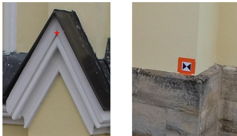
Obr. 20 Vlícovací body, vlevo přirozeně signalizovaný, vpravo uměle signalizovaný
