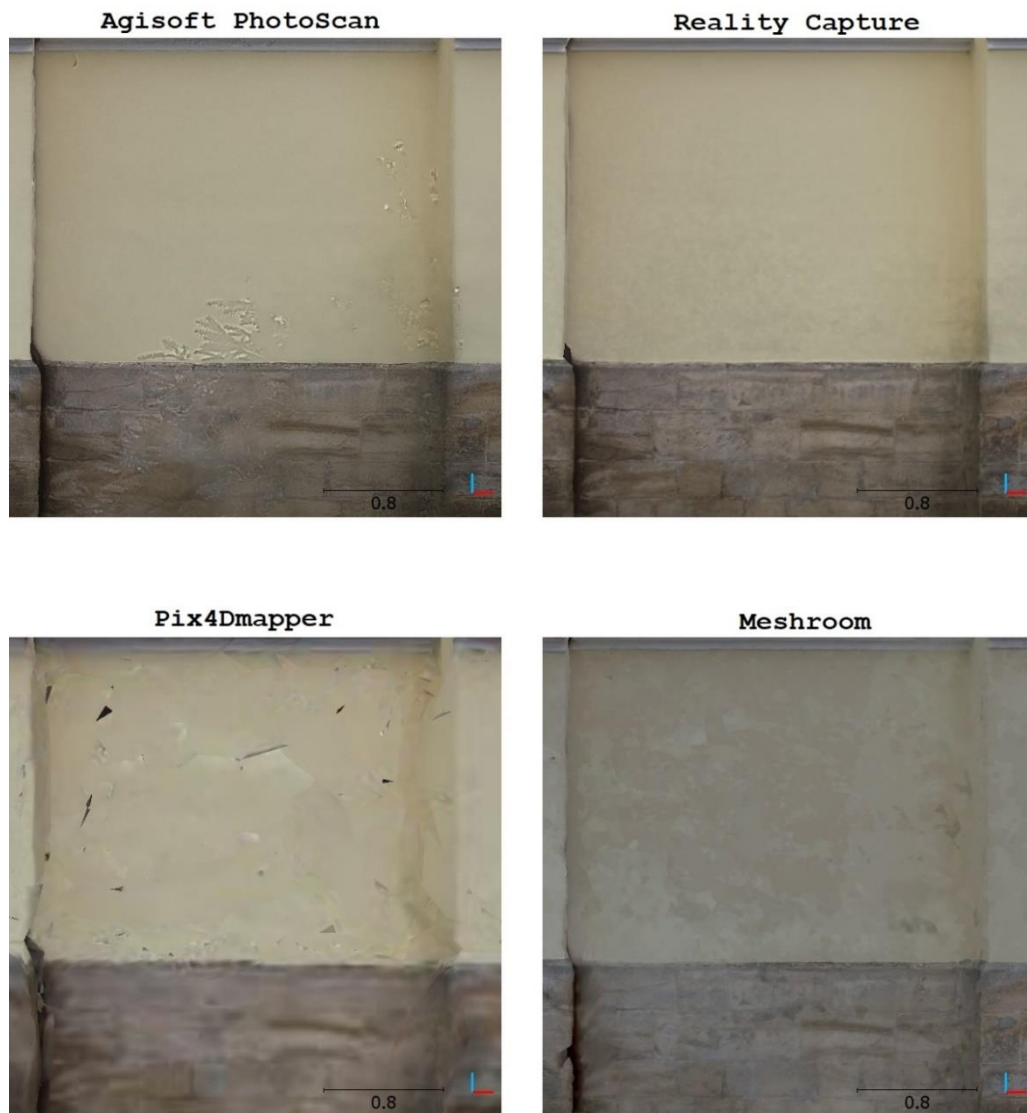
Obr. 52 Porovnání realistických textur přechodu podezdívky a fasády
