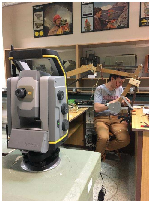
Obr. 10 Testování modelu ramene za pomoci Trimble S7 robotic
