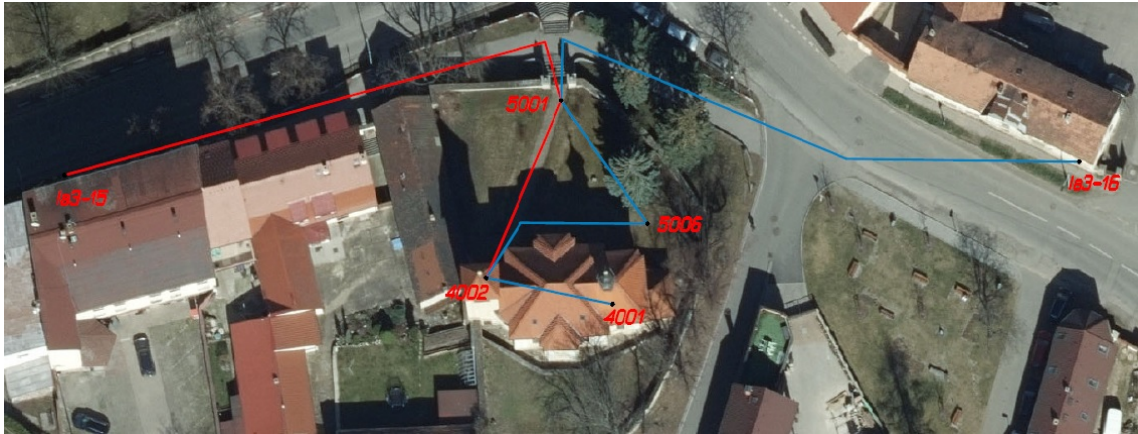
Obrázek 19: Náčrt nivelačního pořadu
