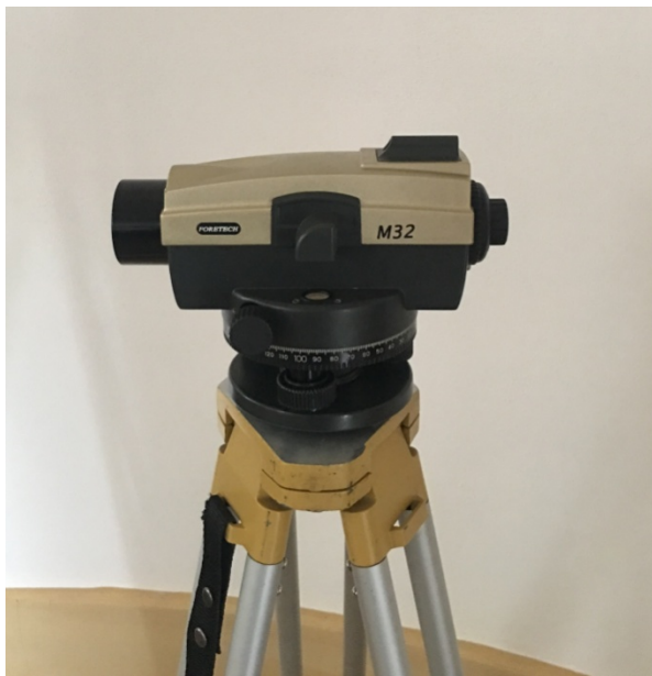
Obrázek 8: Nivelační přístroj Foretech M32
