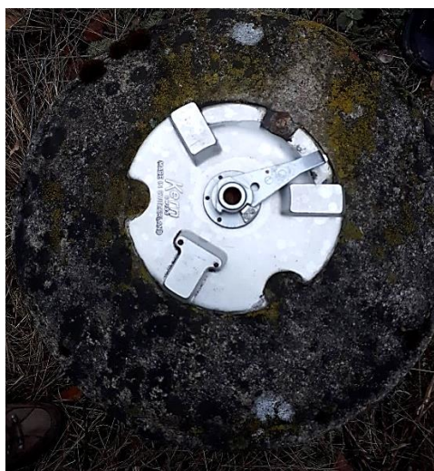
Obr. 9 Pilíř M s nucenou centrací pro přístroje Kern
