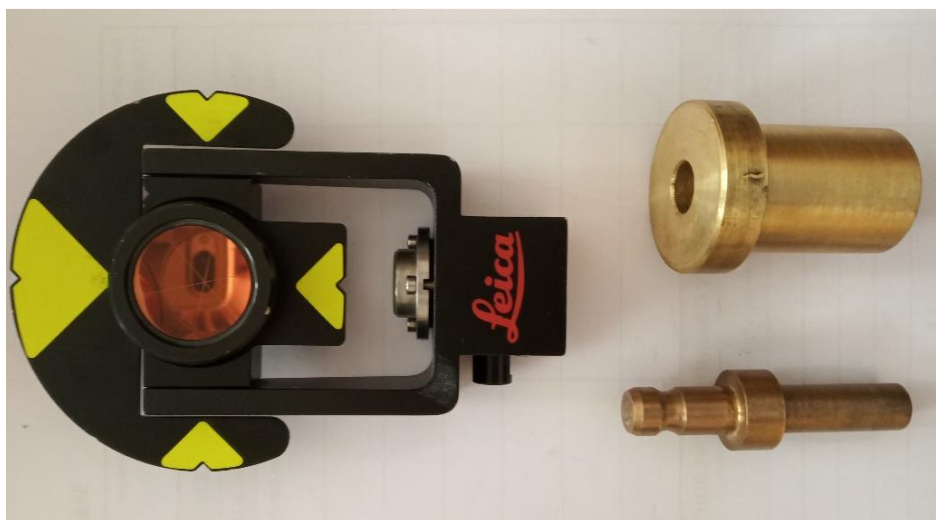
Obr. 13 Pomůcky pro signalizaci pozorovaných bodů – válcový čep, trn, hranol Leica Mini GMP101
