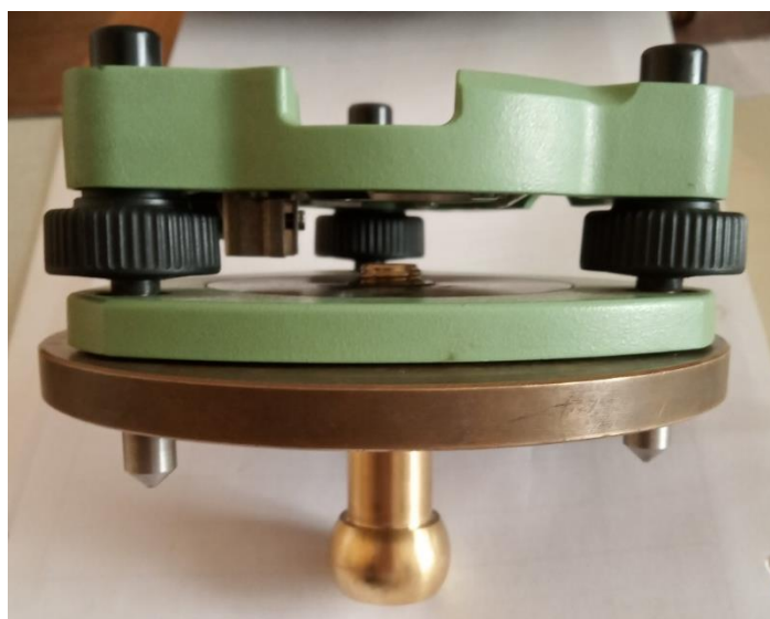
Obr. 12 Základní sestava pro centraci na stanoviskách – kulový čep, centrační talíř, trojnožka
