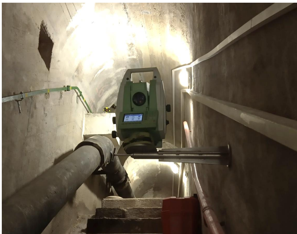
Obr. 16 Leica TM30 na bodě 4001 (centrace pomocí NCC Grid)
