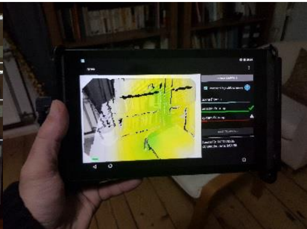
Obr. 67 – Barevné rozlišení intenzity zaměřených bodů (J. Unger 2019)
