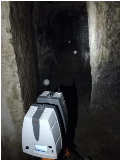
Obr. 54 – Rozmístění kulových terčů ve spojovací chodbě
