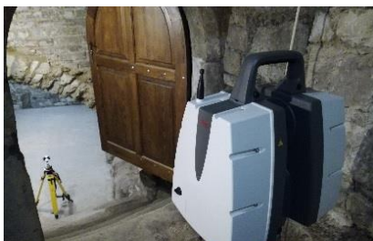
Obr. 51 – Zaměření černobílého terče
