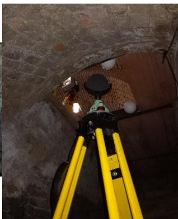
Obr. 52 – Použití kulových terčů
