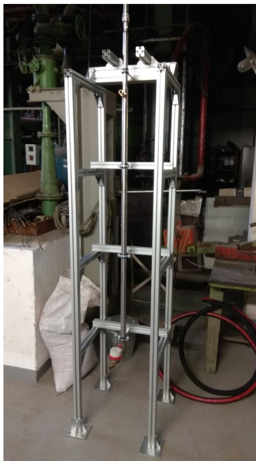
Obr. 6.34 – Model a fotografie kondenzátoru s konštrukci
