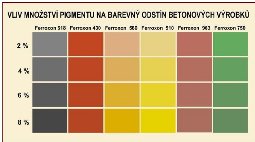
Obr. 33 Vliv množství pigmentu na barevný odstín betonových výrobků (zdroj [39])
