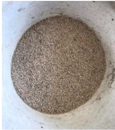
Obr. 60 Křemenný písek PR1-2 (autor BP)
