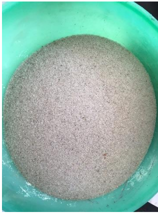
Obr. 59 Křemenný písek PR 31 (0,1-1) (autor BP)
