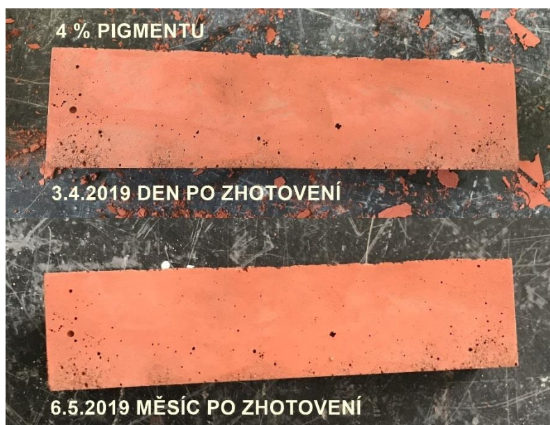
Obr. 69 Porovnání vzorků s 4 % pigmentu (autor BP)
