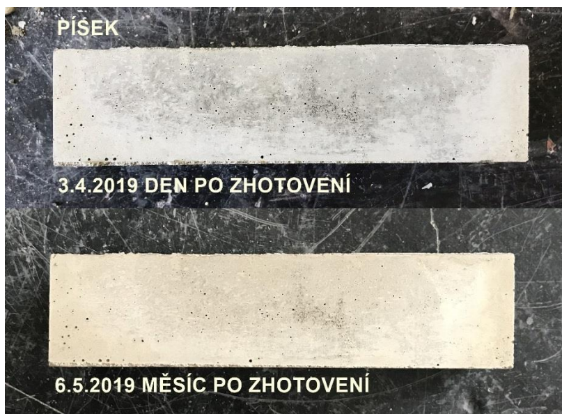
Obr. 72 Porovnání vzorků s pískem (autor BP)
