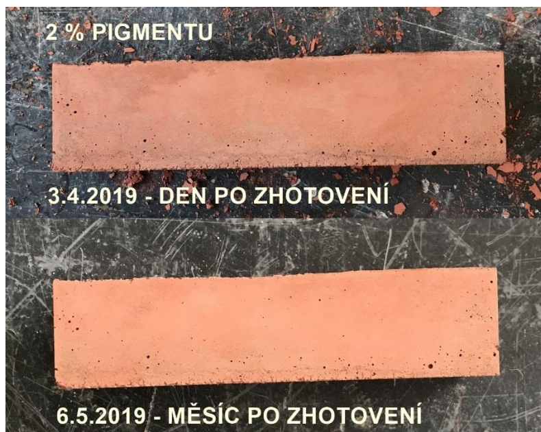
Obr. 68 Porovnání vzorků s 2 % pigmentu (autor BP)
