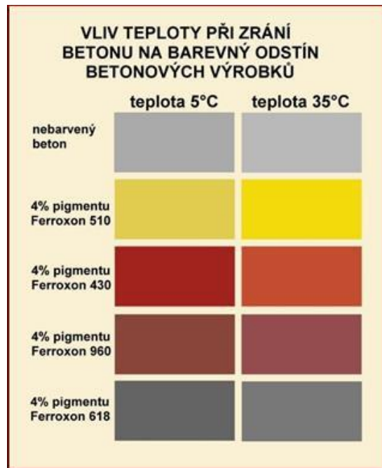
Obr. 37 Vliv teploty při zrání betonu na barevný odstín betonových výrobků (zdroj [39])
