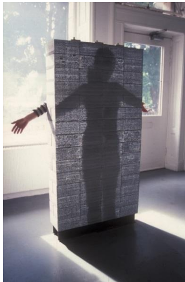
Obr. 27 Ukázka průsvitného betonu (zdroj [31])
