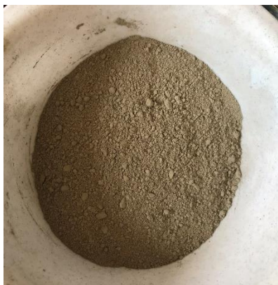
Obr. 56 Cement – EN 197-1 – CEM I 42,5 R (autor BP)
