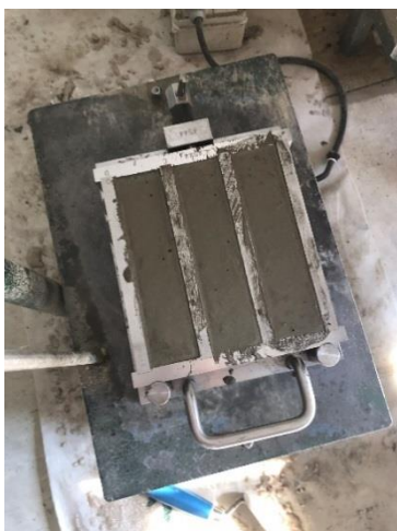
Obr. 63 Zvibrované vzorky (autor BP)
