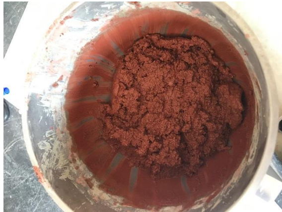
Obr. 65 Čerstvá betonová směs s pigmentem (autor BP)
