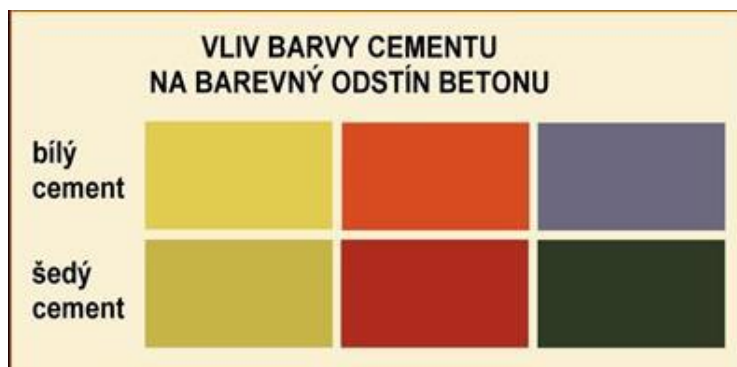
Obr. 34 Vliv barvy cementu na barevný odstín betonu (zdroj [39])
