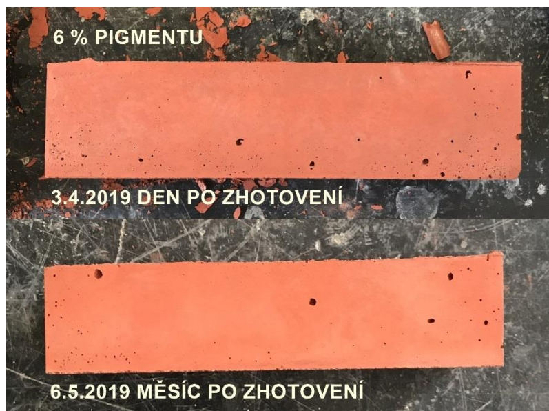
Obr. 70 Porovnání vzorků s 6 % pigmentu (autor BP)
