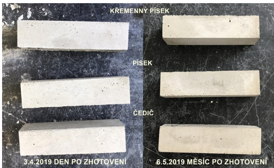
Obr. 75 Porovnání všech vzorků s různým kamenivem (autor BP)
