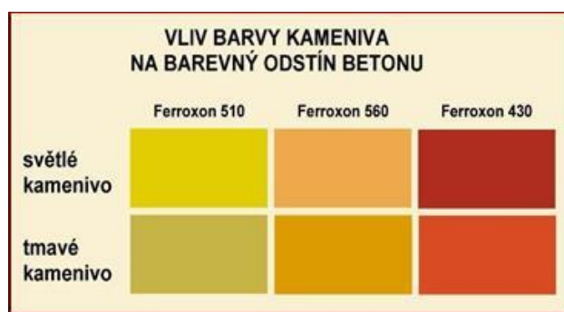
Obr. 35 Vliv barvy kameniva na barevný odstín betonu (zdroj [39])
