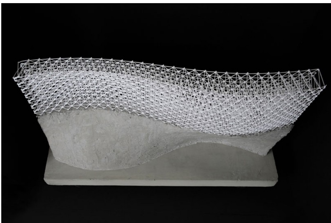
Obr. 2.25: Postupné vlévání cementového kompozitu a manuální uhlazování stran prvku u metody Mesh Mould. [26]
