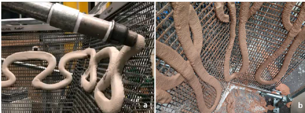
Obr. 2.21: Výsledek druhého experimentu provedeného metodou SCIM. a - nepovedené trasování; b - upravené trasování s menším množstvím aplikovaného materiálu. [15]
