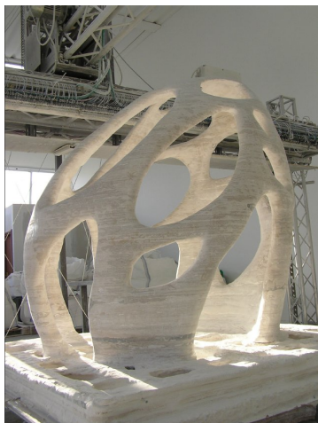
(a) Příklad možných sklonů konstrukce u metody stmelení kameniva [6]
