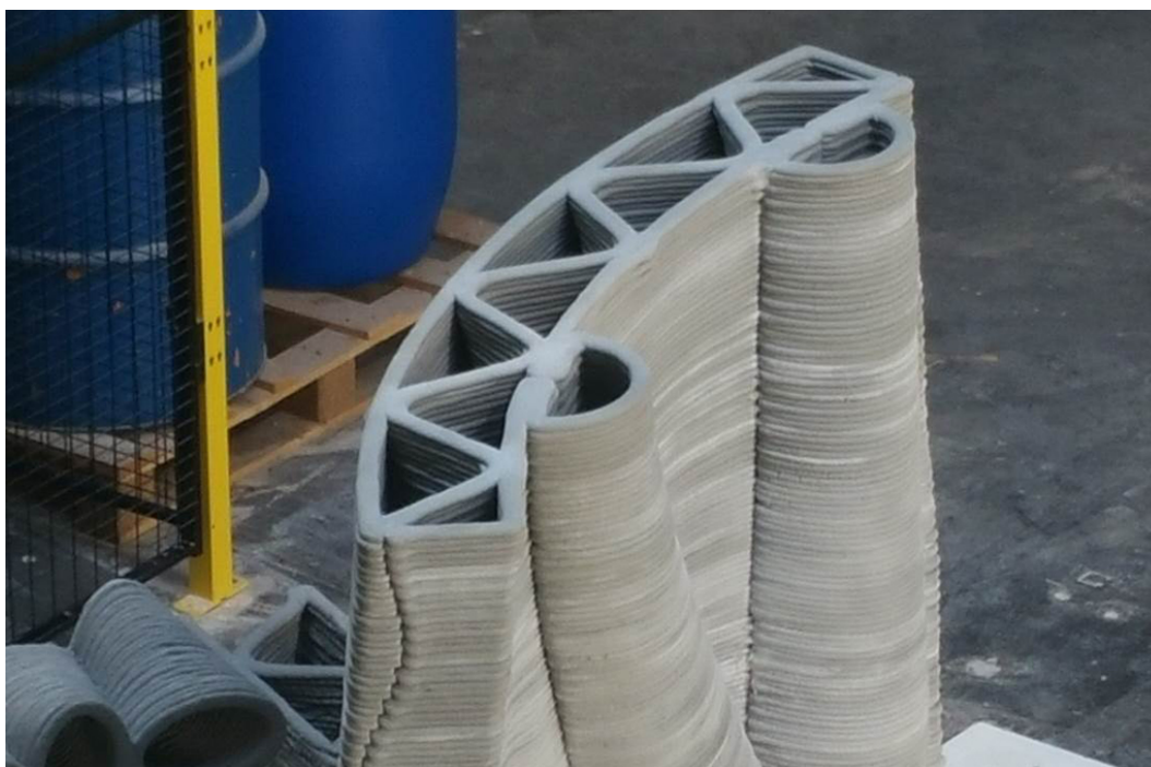
Obr. 3.4: Schéma tisknuté stěny s vnitřní strukturou [30]
