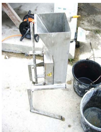
Obr. 61: Pohled na dosometer, který pracuje na principu magnetu – fotografie vložena z interních zdrojů KÚ
