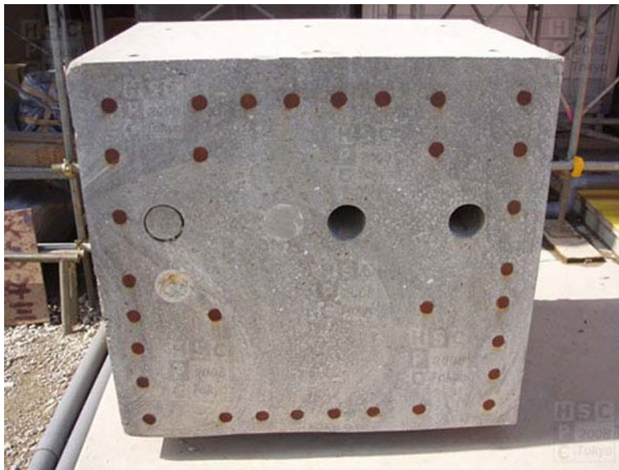
Obr. 23: Odlitek sloupu z UHPC použitého při stavbě Musashi Kosugi Towers v Tokiu [52]
