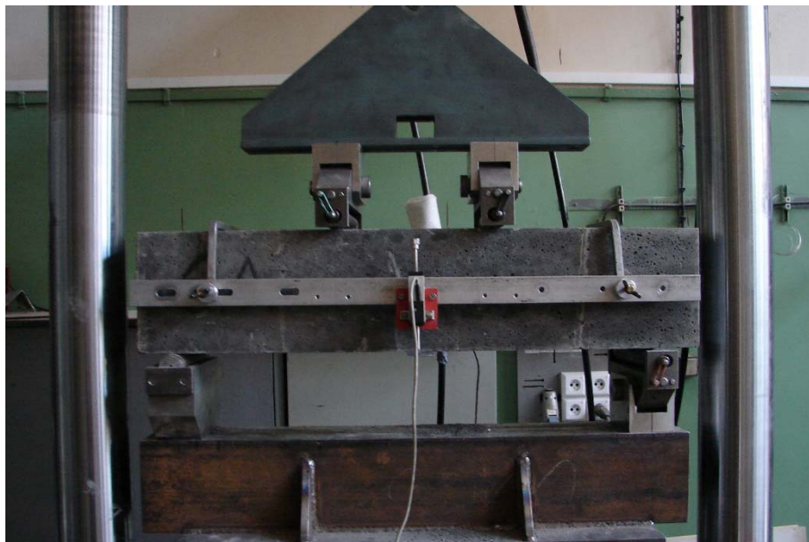
Obr. 52: Fotografie provedené zkoušky pevnosti v tahu za ohybu dle ČSN P 732452 [109], sledován průhyb ve středu rozpětí a posun válce, zkouška provedena autorem ve spolupráci s pracovníky laboratoře Kloknerova ústavu, ČVUT v Praze
