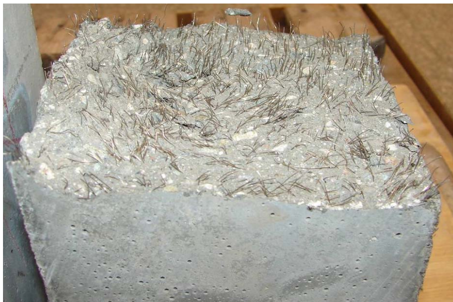
Obr. 67: Lomová plocha trámce 150 \times 150 \times 700 \text{ mm} z UHPC s dávkou vláken 120 \text{ kg/m}^3 , z fotografie je patrné velké množství všesměrně orientovaných drátků, jejichž kvantifikace je početně problematická – fotografie z databáze autora
