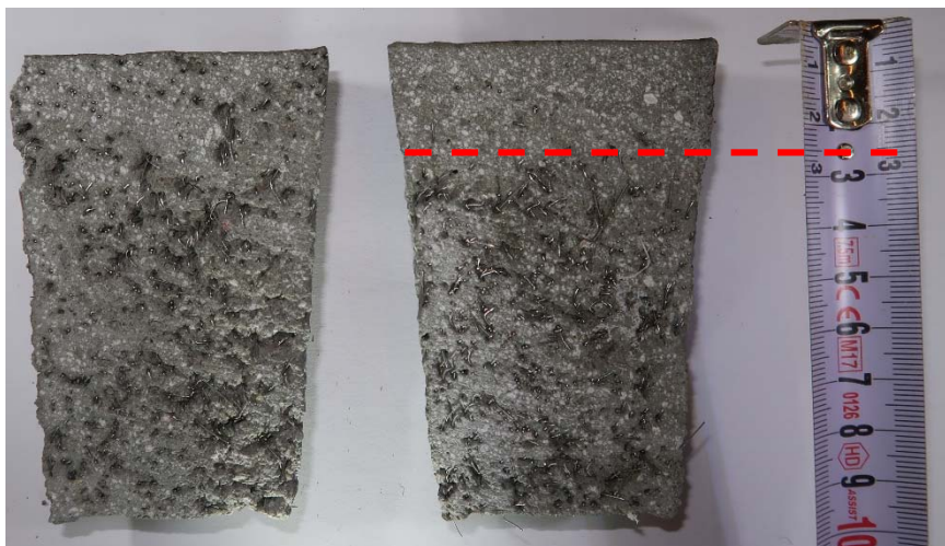
Obr. 82: Porovnání segregace vláken na výchozí směsi (obrázek vlevo) a při zvýšené dávce vody o 20 \text{ kg/m}^3 na zkušebních tělesech tvořených kelímky o objemu 0,3 \text{ l}
