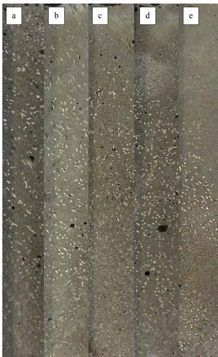
Obr. 62: Vliv přidání vody na distribuci vláken po výšce průřezu; a: původní receptura; b: +10 kg/m 3 ; c: +20 kg/m 3 ; d: +25 kg/m 3 ; e: +30 kg/m 3 – použito z archivu autora
