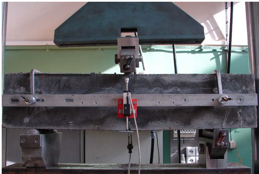
Obr. 47: Fotografie provedené zkoušky pevnosti v tahu za ohybu dle ČSN EN 14651+A1 [94], kromě měření rozevření trhliny sledován i průhyb ve středu rozpětí, zkouška provedena autorem ve spolupráci s pracovníky laboratoře Kloknerova ústavu, ČVUT v Praze
