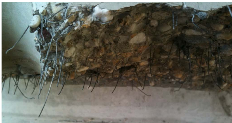
Obr. 66: Lomová plocha vláknobetonu s dávkou vláken 40 \text{ kg/m}^3 , na lomové ploše počítatelné množství kovových drátků – fotografie z databáze autora
