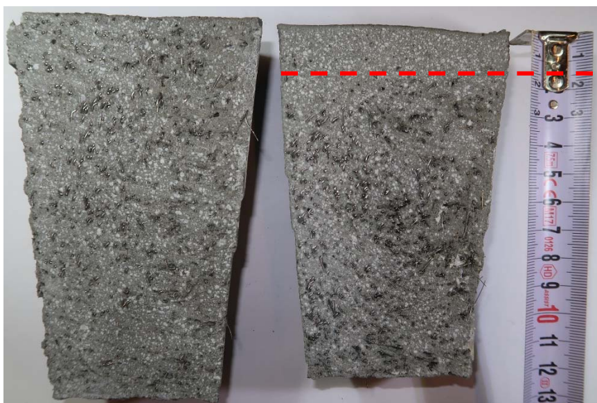
Obr. 81: Porovnání segregace vláken na výchozí směsi (obrázek vlevo) a při zvýšené dávce vody o 20 \text{ kg/m}^3 na zkušebních tělesech tvořených kelímky o objemu 0,5 l
