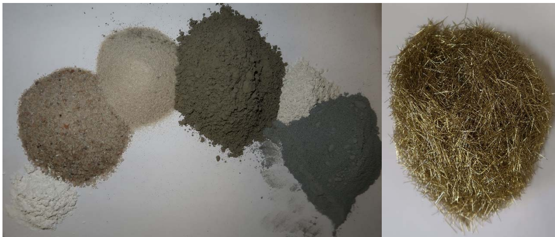
Obr. 78: Pohled na jednotlivé složky receptury Mix 3; na fotografiích zleva mletý křemen, hrubé kamenivo s D_{\max} = 2 mm, jemné kamenivo s D_{\max} = 0,5 mm, cement CEM I 52,5 R, struska, mikrosilika, ocelové drátky
