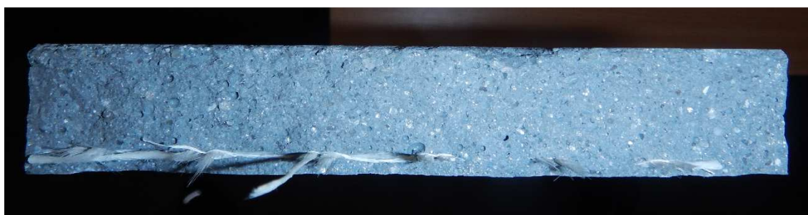
Obr. 85 Příčný řez zlomené desky 1100/120/20 mm, poloha výztuže cca 3 mm od dolního líce
