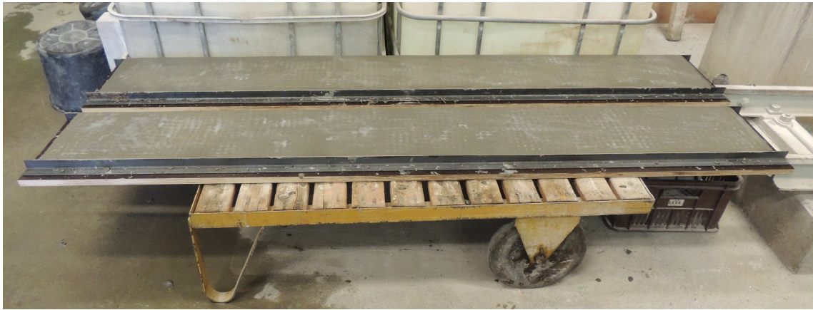
Obr. 84 Vzorky desek o rozměru 2000/250/30 mm vyrobené laminováním na transportním vozíku, povrch je opatřen nátěrem proti odparu
