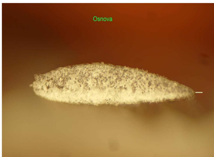
Obr. 62 Reálný tvar rovingu textilní skleněné výztuže získaný z 2D sítě
