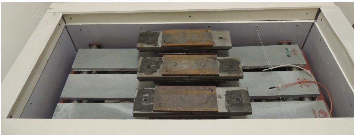
Obr. 110 Vzorky D1, D2 a D3 umístěné v tepelné komoře, zatížené silou 200 N
