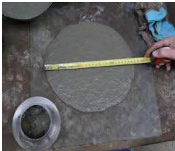
Obr. 5 Zkouška zpracovatelnosti čerstvého UHPC s využitím zkušební metody pro malty dle EN 1015-3 [15]
