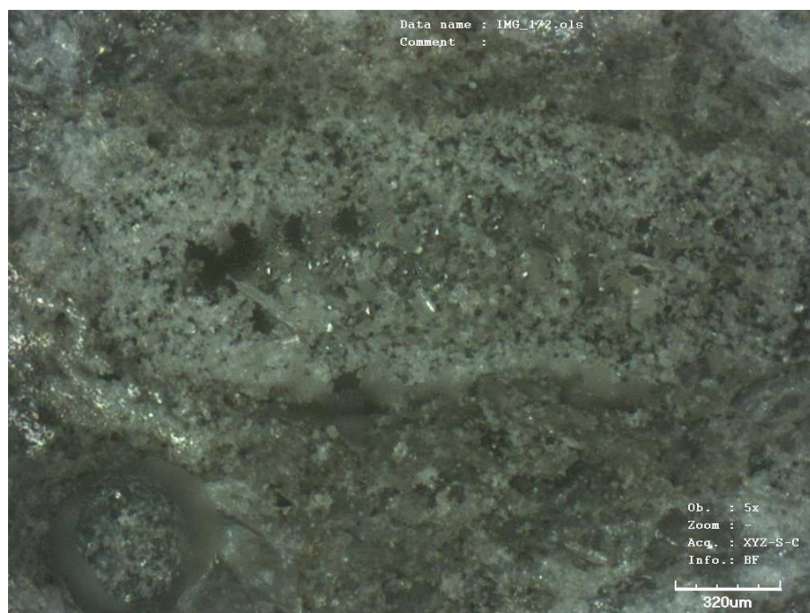
Obr. 118 Pohled na povrch řezu s rozhraním betonové matrice a skelné výztuže
