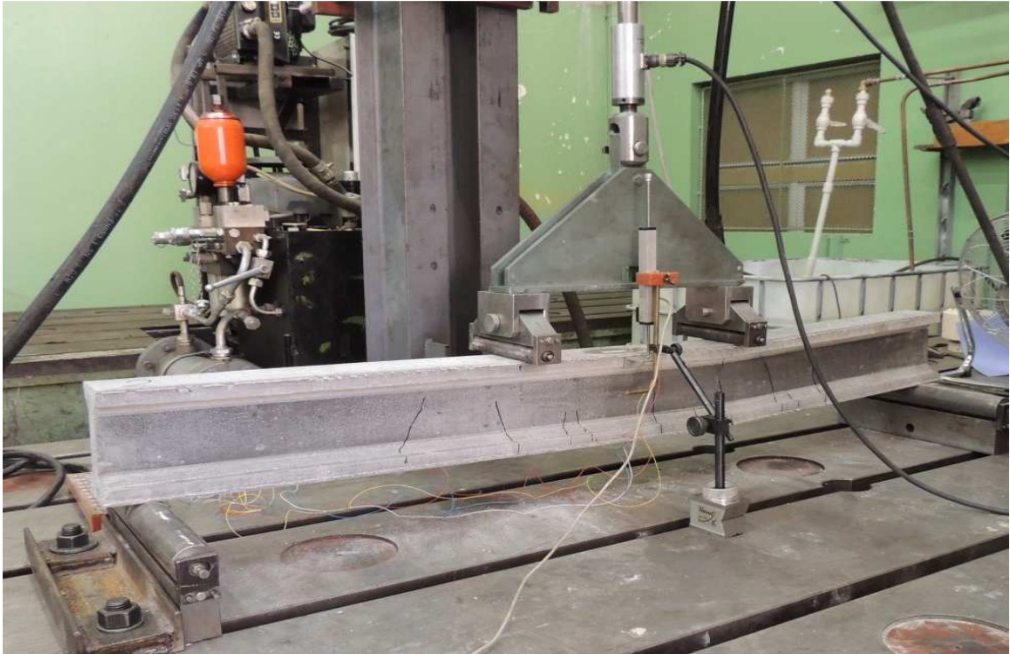
Obr. 100 Průběh zkoušky ve čtyřbodovém ohybu vzorku TRC s textilní skleněnou výztuží včetně naznačení polohy trhlin, vzdálenost podpor 1,4 m, vzdálenost válečků vahadla 0,4 m (v ose prvku)
