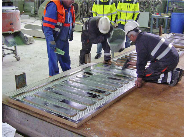
Obr. 42 Výroba vylehčených zábradelních panelů u TRC [59][60]
