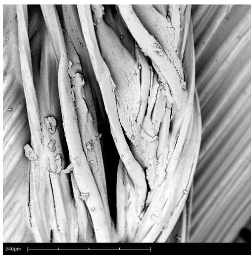
Obr. 82 Snímek zobrazující lokální popraskání ochranného organického povlaku, expozice po 2 týdnech při pH 13,5
