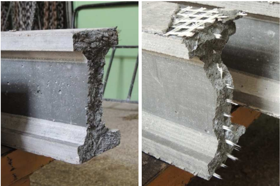
Obr. 101 Lomové plochy zkoušených vzorků, vlevo vzorek UHPC s ocelovými drátky, vpravo vzorek z TRC s přidáním textilní skleněné výztuže ve formě AR-Glass
