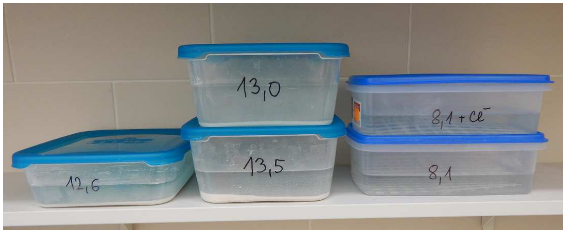
Obr. 71 Expozice textilní skelné výztuže v modelových pórových roztocích betonu o různém pH a různé kontaminaci ( \text{CO}_2 ; \text{Cl}^- ) v plastových boxech
