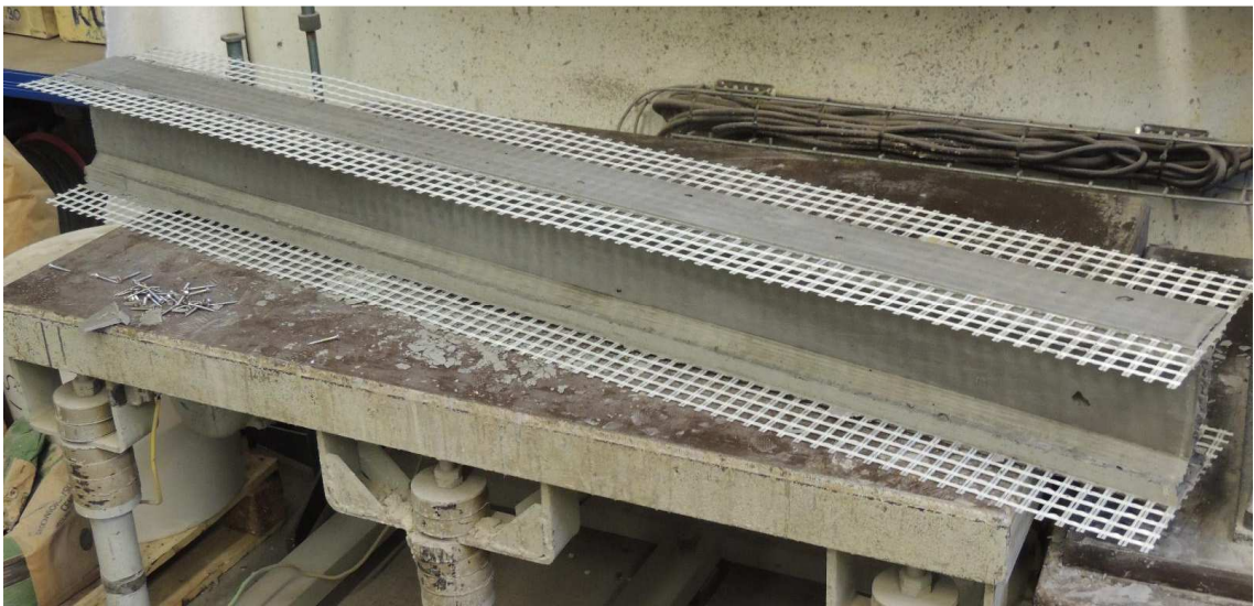
Obr. 99 Odformovaný vzorek I nosníku s textilní skleněnou výztuží před vložením do vodního uložení
