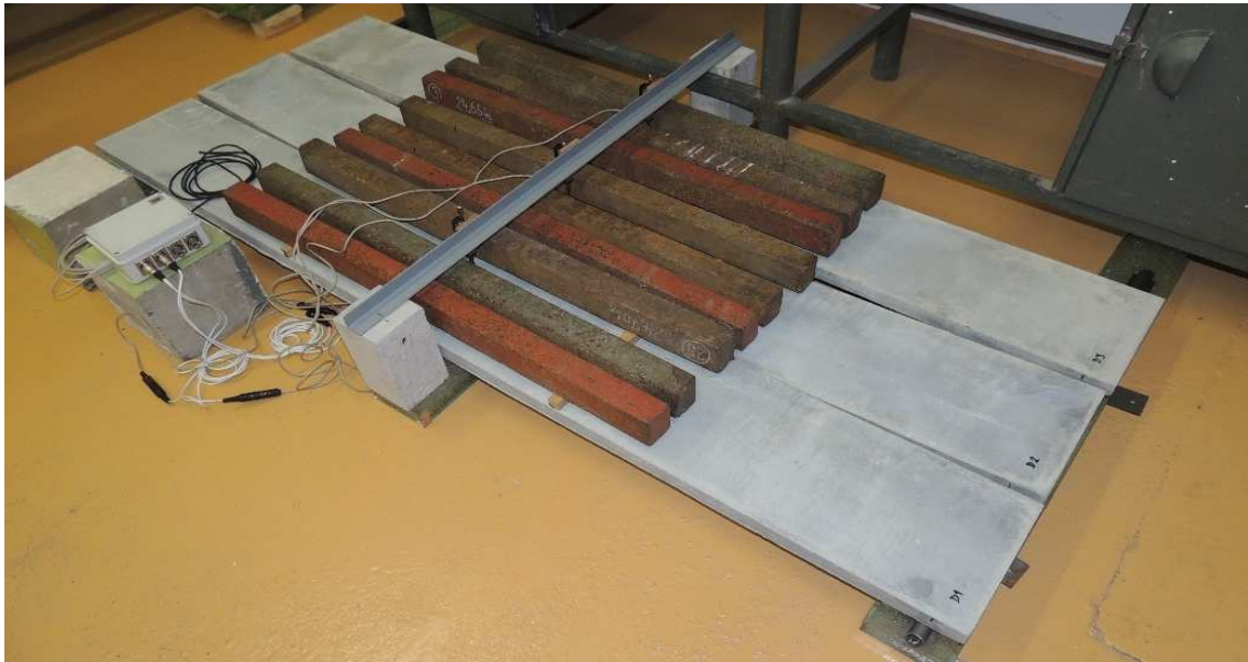
Obr. 105 Uspořádání dlouhodobé zkoušky ve čtyřbodovém ohybu, vzdálenost podpór 1,9 m, břemena vzdálena 0,65 m, umístěna symetricky v ose prvků
