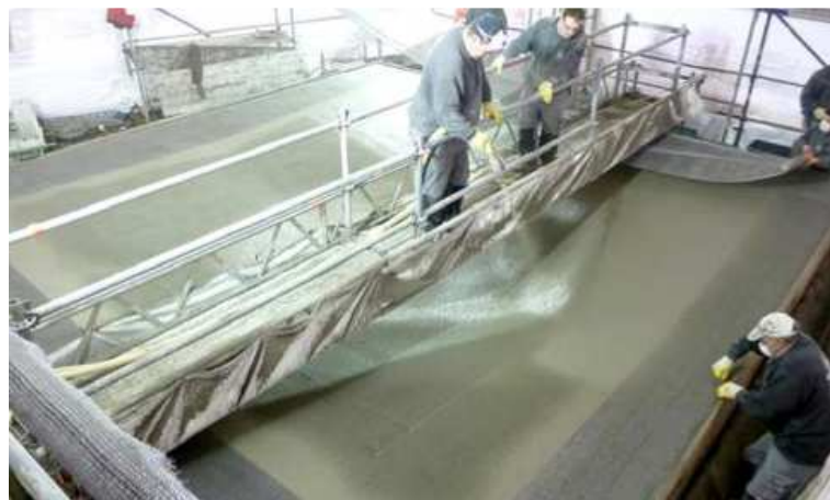
Obr. 29 Laminování velkoformátové desky z TRC [92]
