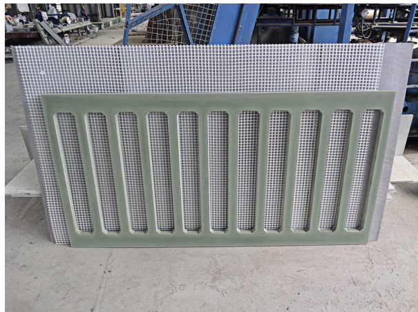
Obr. 43 Vylehčený panel z TRC s výztužnou sítí po odbednění [59][60]
