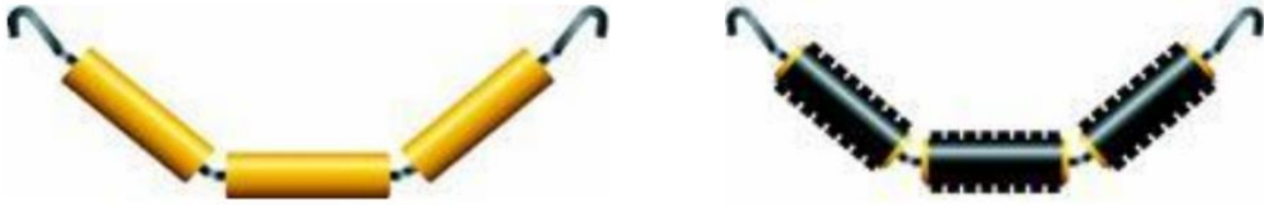
obr. 16.: Girlandové stolice s hladkými válečky (vlevo) [6] a s kotoučovými válečky (vpravo) [12]
