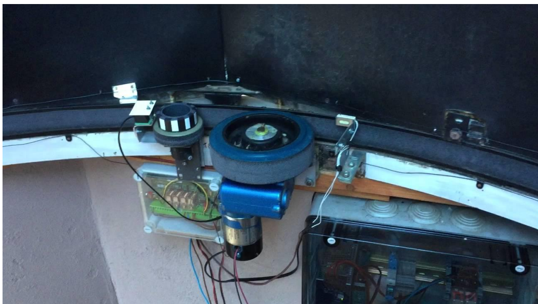
Obr. 1.: Řešení pohonu pomocí třecího převodu [1]
