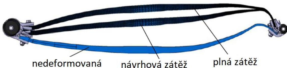
Obr. 16: Zobrazení namáhání pružiny [6]
