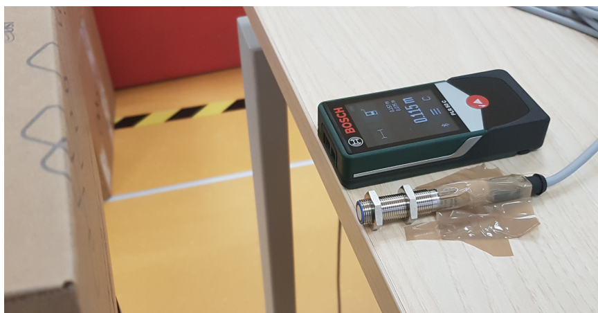
Obrázek 3.3: Naměření dat pro kalibraci pomocí referenčního laserového dálkoměru
