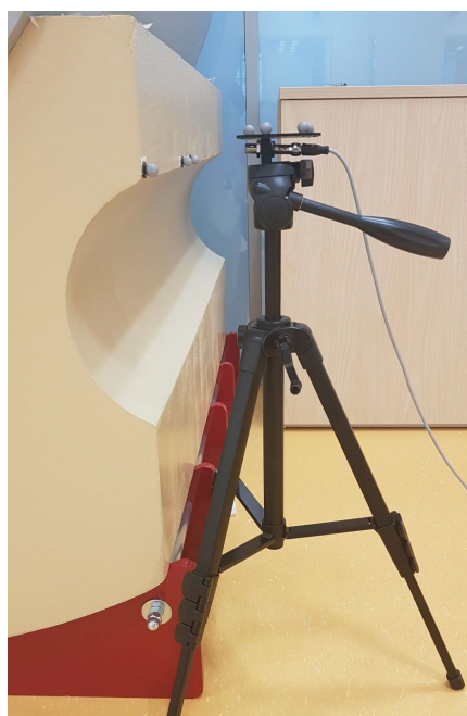
(b) : Umístění senzoru UM12 a lokalizační značky Vicon
