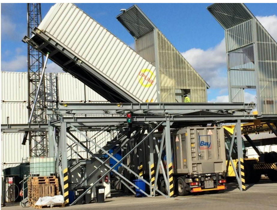
Obrázek č. 12: Přesypávání materiálu z kontejneru do autocisterny; zdroj: [autor]
