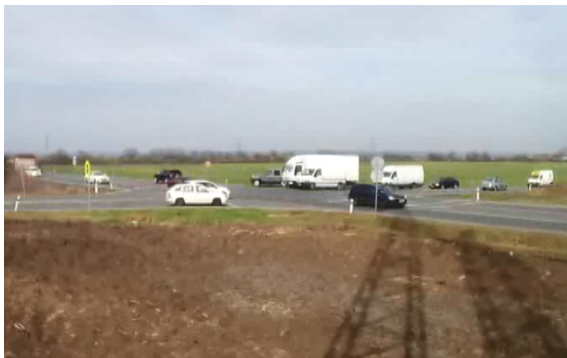
Obrázek 16 – Ukázka chybného řazení vozidel „vedle sebe“ při vyčkávání na připojení na hlavní komunikaci v místě vedlejšího ramena křižovatky.
