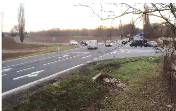
Obrázek 27 – Ukázka levého odbočení z hlavní komunikace při nuceném využití průběžného jízdního pruhu pro opačný směr jízdy.
