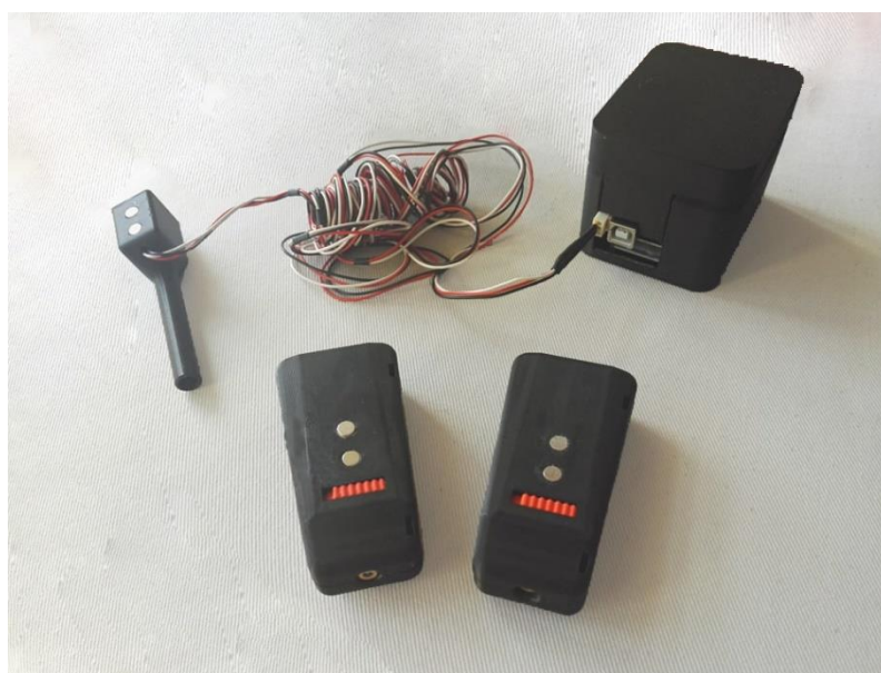
Obrázek 23: Vytvořené měřicí zařízení včetně dvou laserových vysílačů
