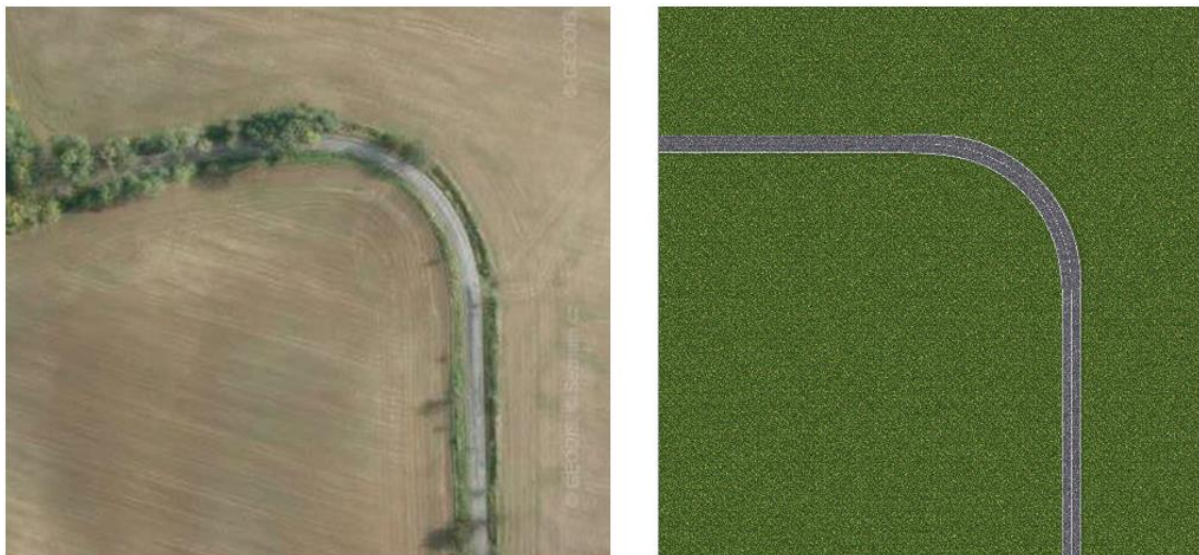
Obrázek 25: Oblouk s poloměrem R50 - příklad porovnání reálného měřeného oblouku (vlevo) a příslušného segmentu s obloukem (vpravo)
