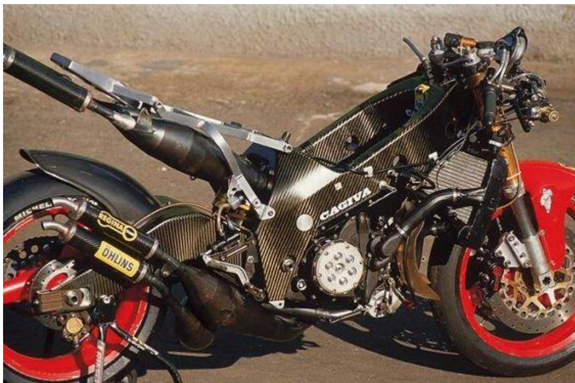
Obrázek 21 - Závodní motocykl Cagiva GP500 C194 (1994) s rámem z kompozitních materiálů [45]
