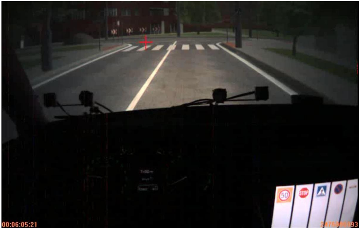
Obrázek 15 – Vlastní fotografie ze simulátoru na K616 FD ČVUT při simulaci možnosti zobrazování dopravního značení přímo ve vozidle
