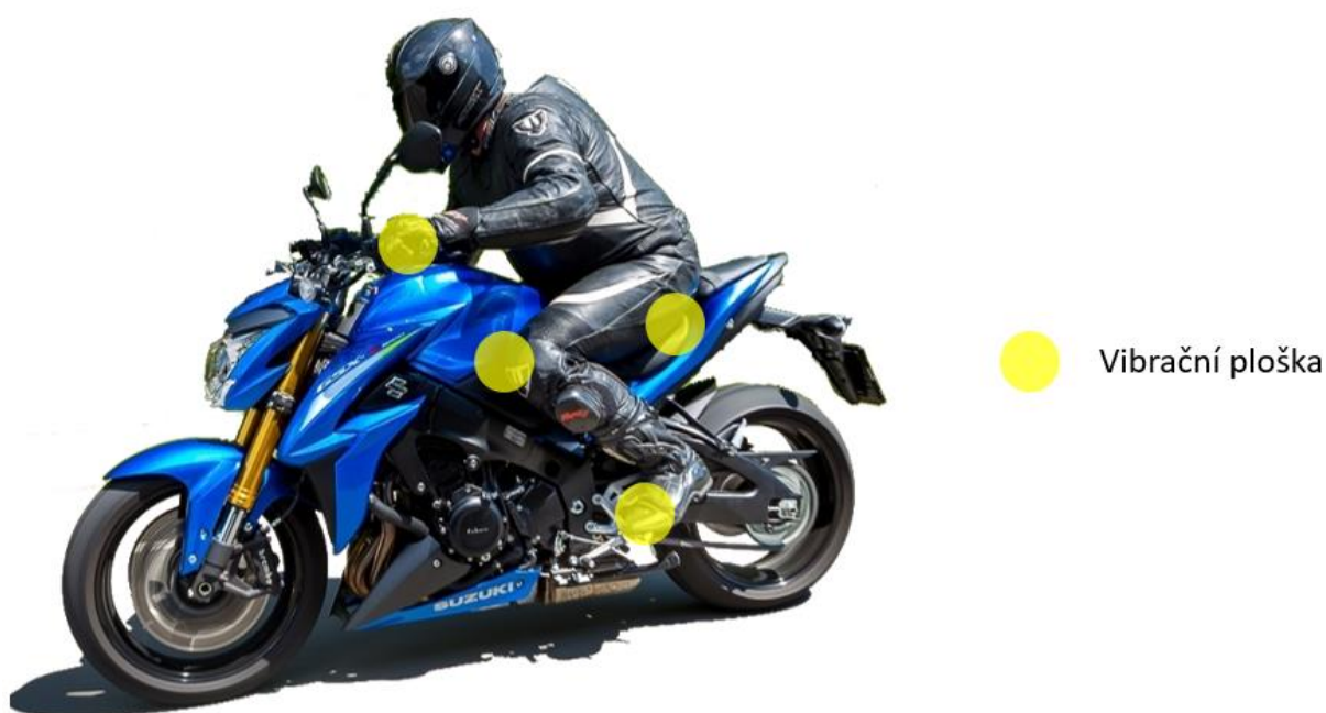
Obrázek 22 - Vibrační plošky na motocyklu; upravený obrázek z [46]
