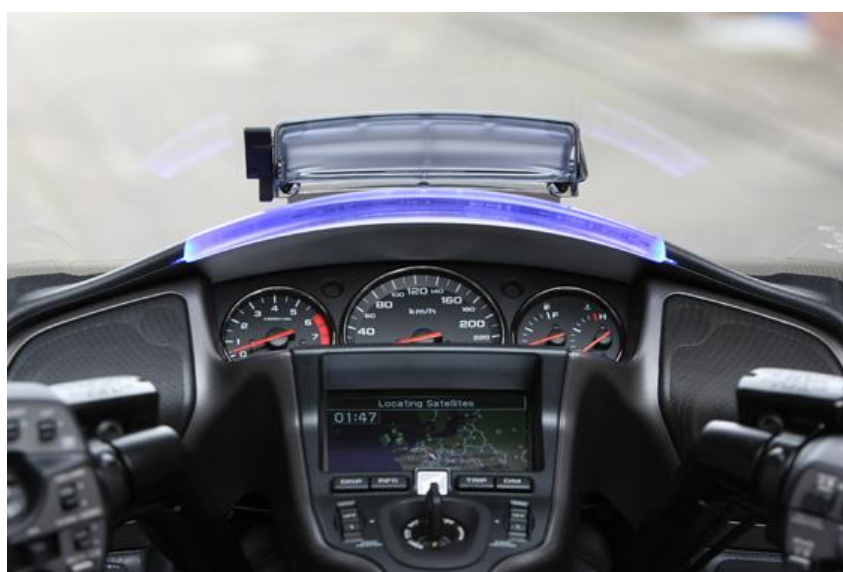
Obrázek 30 - Přístrojová deska s prvky HMI pro kooperativní systémy v projektu Honda ASV-4 [58]
