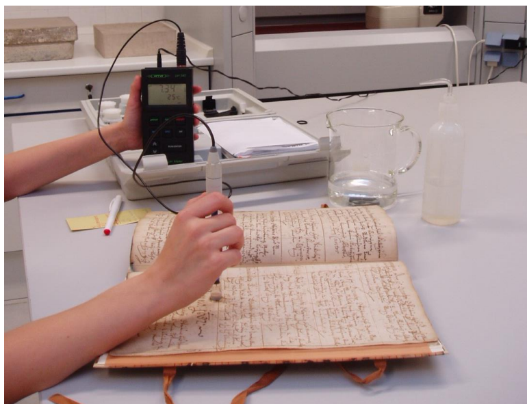
Obr. 6 Měření pH metrem s dotykovou elektrodou
