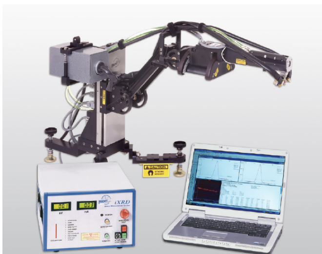
Obrázek 4.6: Fotografie přístroje PROTO iXRD COMBO používaného v Laboratoři aplikované strukturní rentgenografie TU v Liberci. [53]
