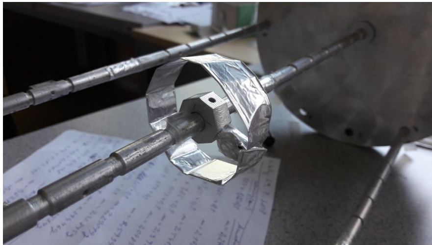
Obrázek 23: Uchycení testovaných diod na experimentální držák
