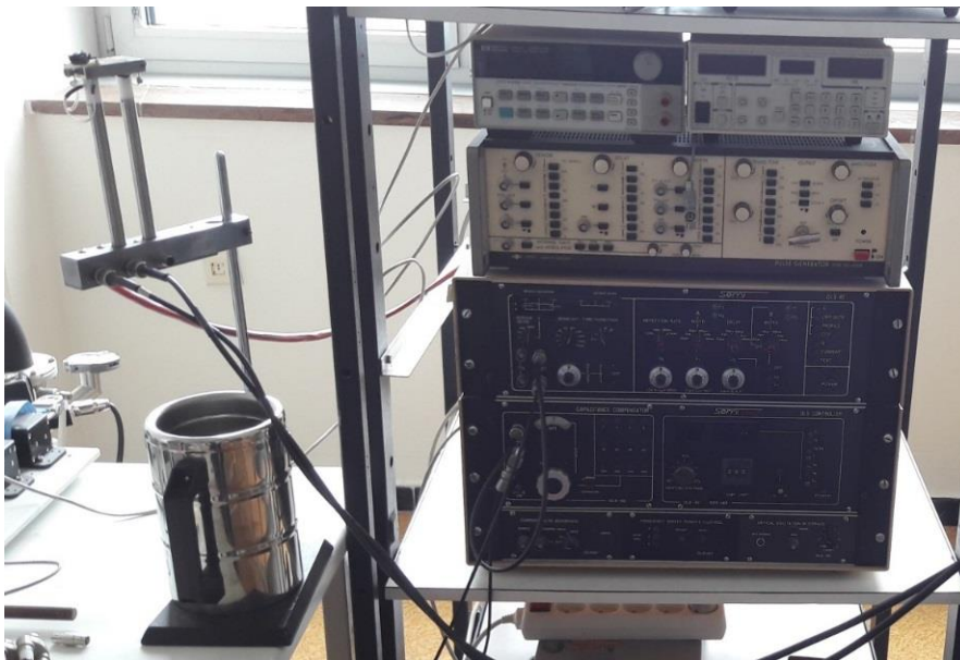
Obrázek 37: DLS-82E (vpravo), přípravek pro uchycení a následné ponoření DUT do tekutého dusíku (vlevo)
