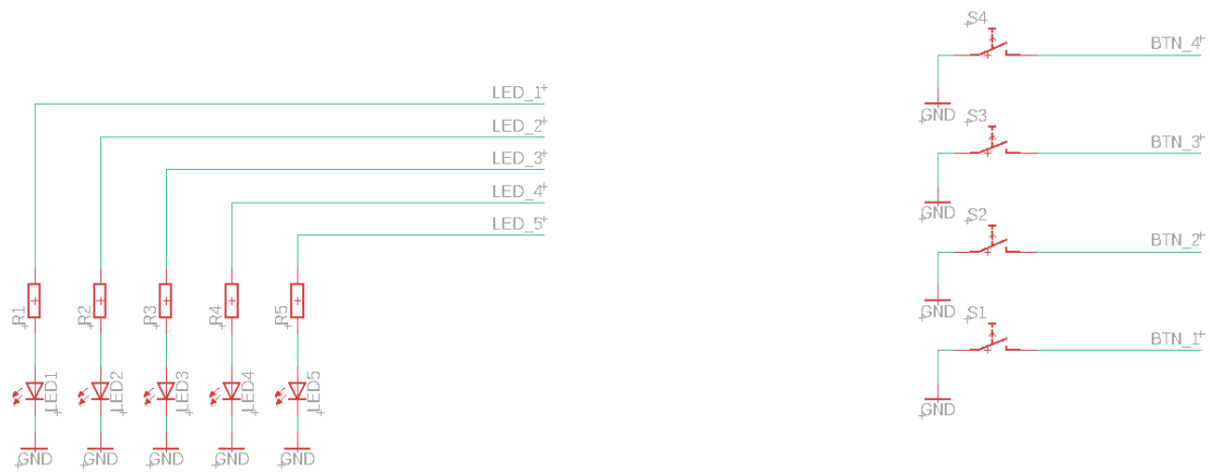
Obr. II-3 Zapojení tlačítek a indikačních diod
