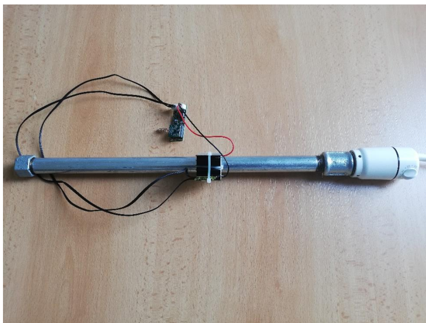
Obr. 7.1-2 Detail senzoru v konfiguraci s termoelektrickým článkem na rozvodech teplé vody
