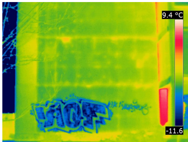
Obrázek 1: Chyba měření teploty způsobena rozdílnou emisivitou povrchů [7]
