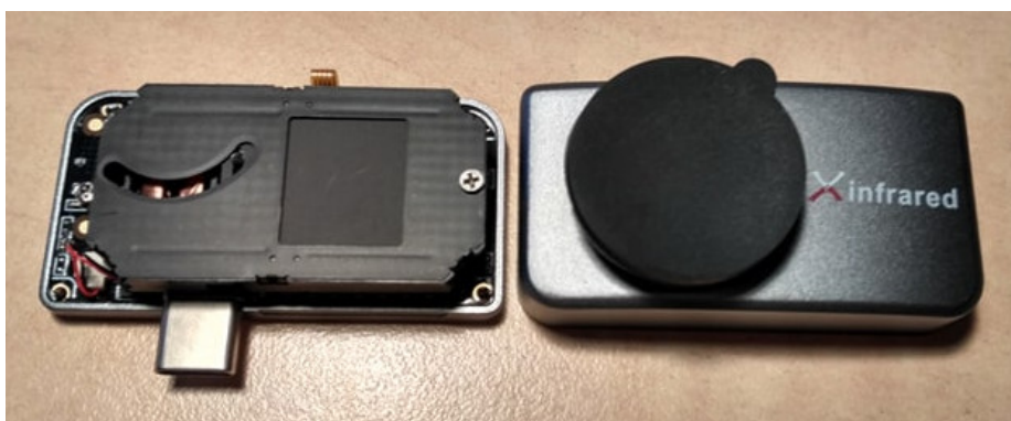
Obrázek 10: Fotografie rozebrané termokamery
