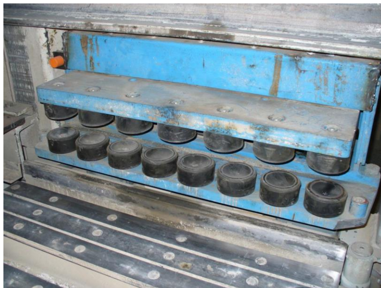
Obrázek 5 Pohled na uspořádání silentbloků v rámu vibrolisu Zdroj Synáč V. [63]
