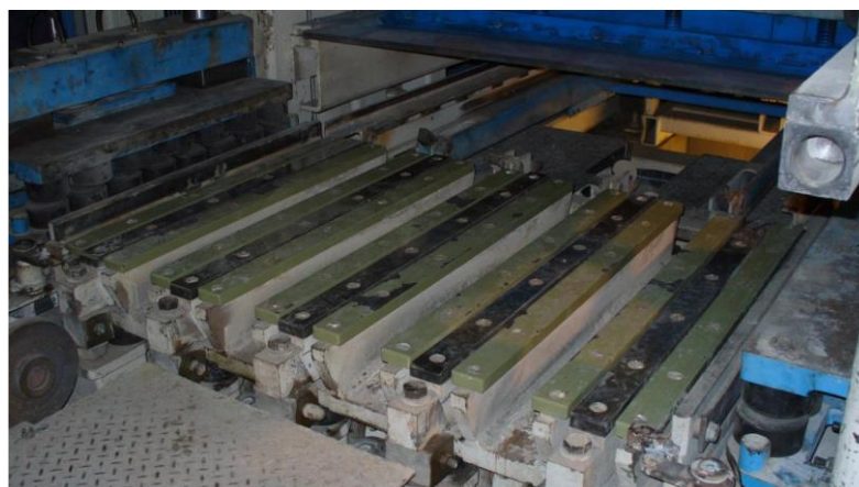
Obrázek 4 Pohled na vibrační (zelené) a dorazové (černé) lišty vibrolísu Zdroj Synáč V. [63]
