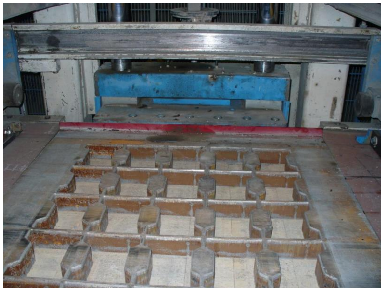
Obrázek 3 Pohled na formu upnutou ve vibrolísu Zdroj Synáč V. [63]
