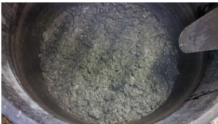
Obrázek 19 Čerstvá směs betonu po namíchání Zdroj: archiv autora.
