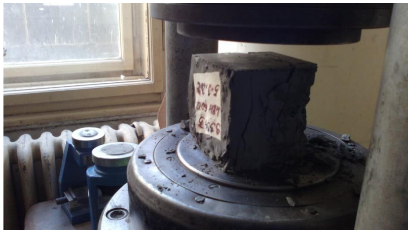
Obrázek 24 Vzorek po pevnostní zkoušce v tlaku Zdroj: archiv autora.
