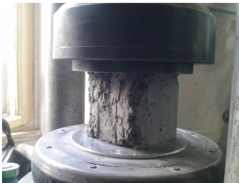
Obrázek 23 Vzorek umístění v lisu před zkouškou pevnosti v tlaku Zdroj: archiv autora.
