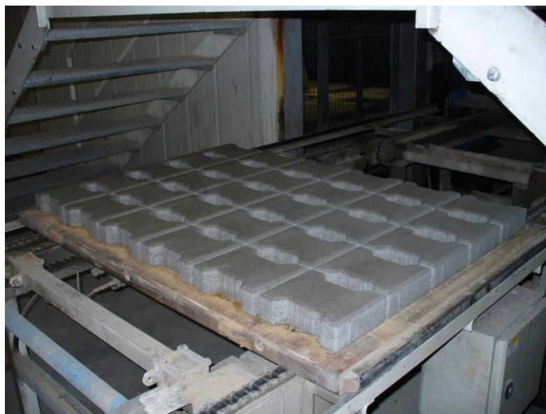
Obrázek 6 Pohled na zhuštěné betonové výrobky umístěné na podložce Zdroj Synáč V. [63]
