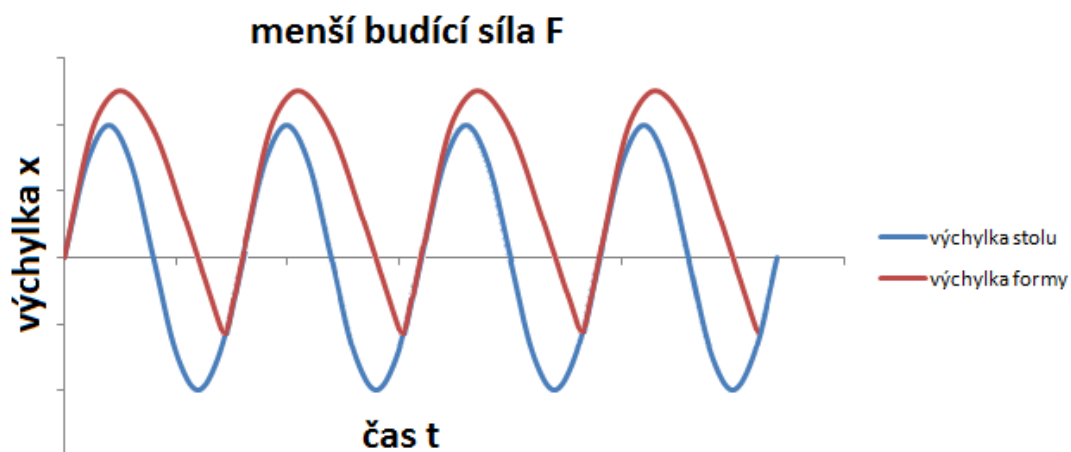
Obrázek 7 Vliv menší budící síly na odlehnutí formy od stolu Zdroj Synáč V. [63]
