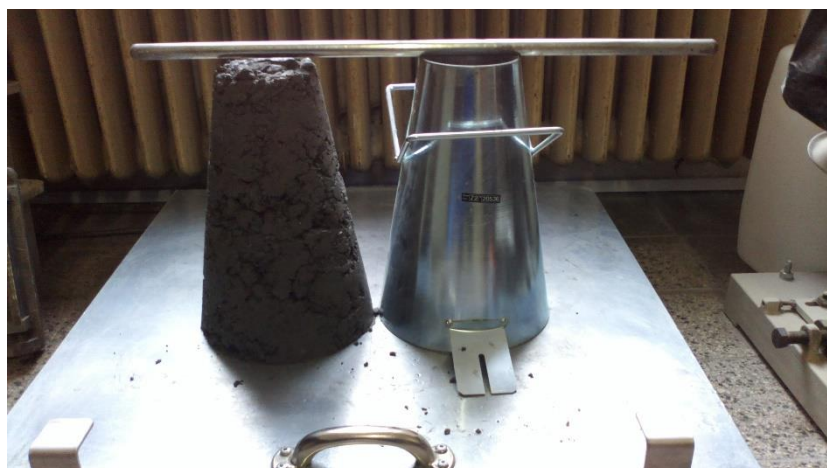
Obrázek 25 Zahájení měření výšky kužele při zkoušce zpracovatelnosti Zdroj: archiv autora.
